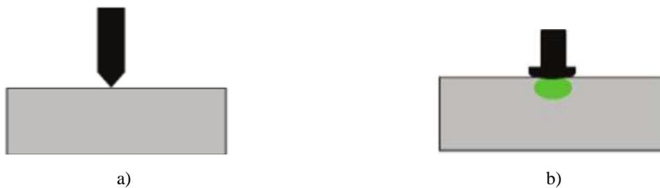
*Figure 1.2: Schémas illustrant a) l'approche d'un projectile vers une cible et b) au moment de l'impact du projectile dans la cible [19]*
