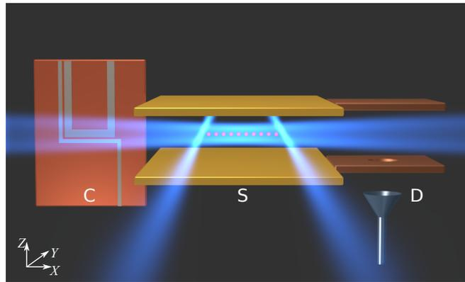
**Figure V.26** Schéma de principe du dispositif expérimental adapté au simulateur quantique. Les atomes dans l'état fondamental sont piégés et refroidis devant la puce (*C*) puis transportés dans le condensateur de science (*S*). Dans ce condensateur, la chaîne d'atomes de Rydberg est préparée et la simulation a lieu. Les atomes de Rydberg sont ensuite envoyés un par un dans la zone de détection (*D*) où ils sont ionisés.
