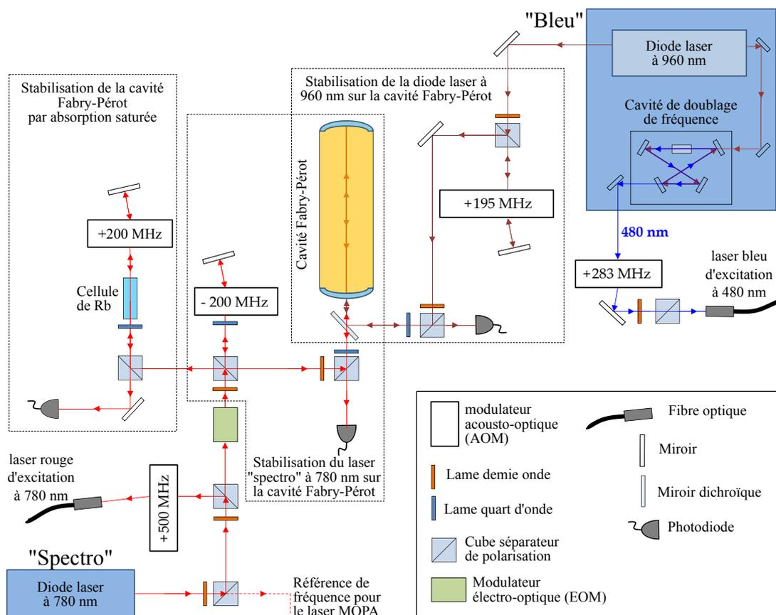
**Figure A.1** Schéma de stabilisation en fréquence des lasers d'excitation Rydberg.
