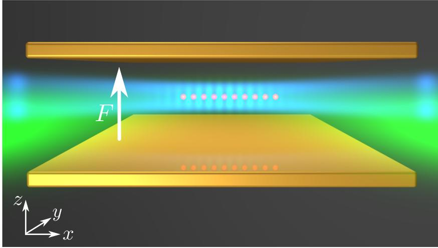
**Figure IV.1** Schéma de principe du simulateur quantique proposé. Les atomes de Rydberg circulaires, représentés par les sphères rouges, sont placés dans un condensateur et piégés dans des faisceaux laser : un faisceau « creux » selon l'axe  $Ox$ , représenté en bleu, et un réseau ajustable créé par l'interférence de deux faisceaux quasi-parallèles, représentés en vert. Un champ électrique  $F$  est imposé entre les deux plaques du condensateur, selon l'axe  $Oz$ .
