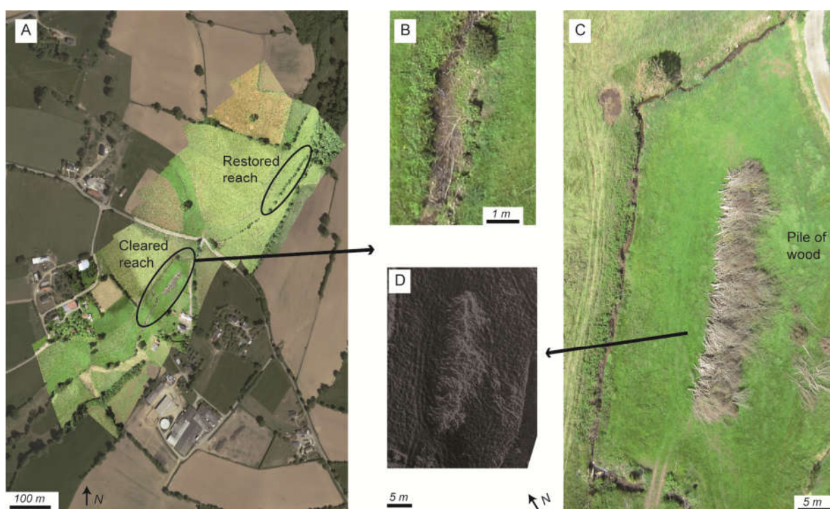
Figure 37. Illustration de l'apport de l'imagerie à très haute résolution spatiale pour l'étude des corridors fluviaux (d'après Dufour et al. , 2013). A : mosaïque d'images drone d'une résolution spatiale de 5 cm drapée sur les orthophotographies IGN ; B : agrandissement du chenal après l'entretien de la ripisylve, les branches coupées tombées dans le chenal sont visibles ; C et D : création à partir des images d'un modèle numérique de surface permettant une caractérisation des objets non seulement en plan, mais aussi en volume.
