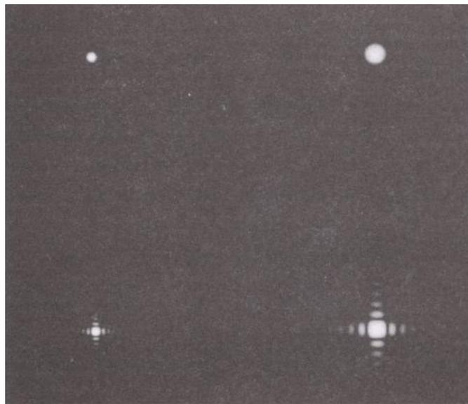
FIGURE 2.10: Les deux PSF du haut sont circulaires symétriques et causées par des turbulences atmosphériques, plus importantes à droite. Les deux PSF du bas représentent la PSF d'un système d'ouverture carré limité par la diffraction, dont l'ouverture est plus petite à droite. Figure issue de [L65].
