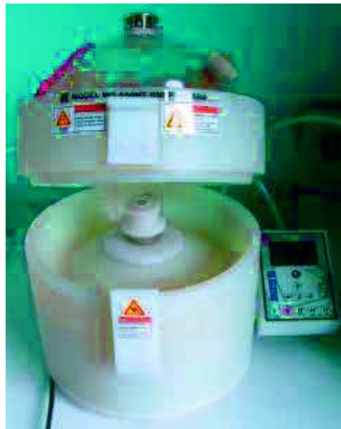
Figure 22 : Spincoater utilisé pour réaliser les dépôts par enduction centrifuge
