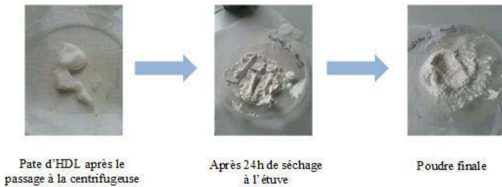
Figure 32 : Schéma des étapes pour l'obtention d'une poudre
