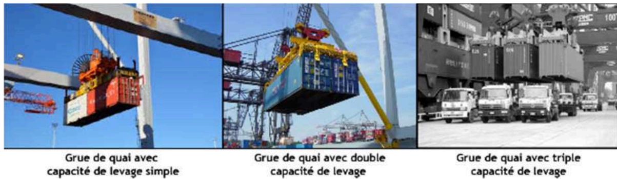
Figure I.9 Capacité de levage des grues de quai
