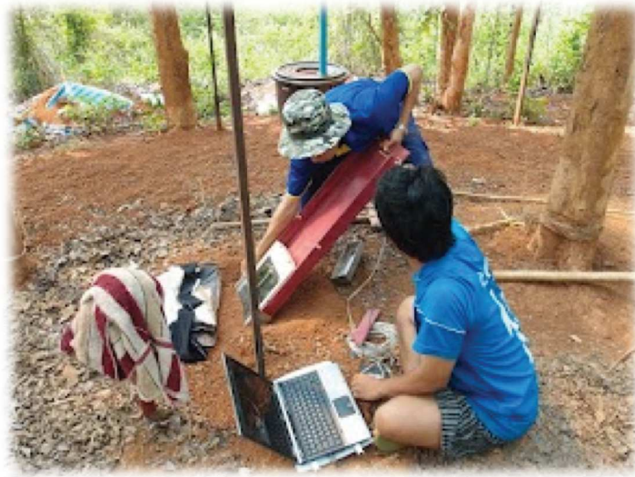
Photo 3 : Insertion et positionnement d'un scanner plat pour la prise d'images racinaires sous plantation de teck (Maeght et al., 2012)
