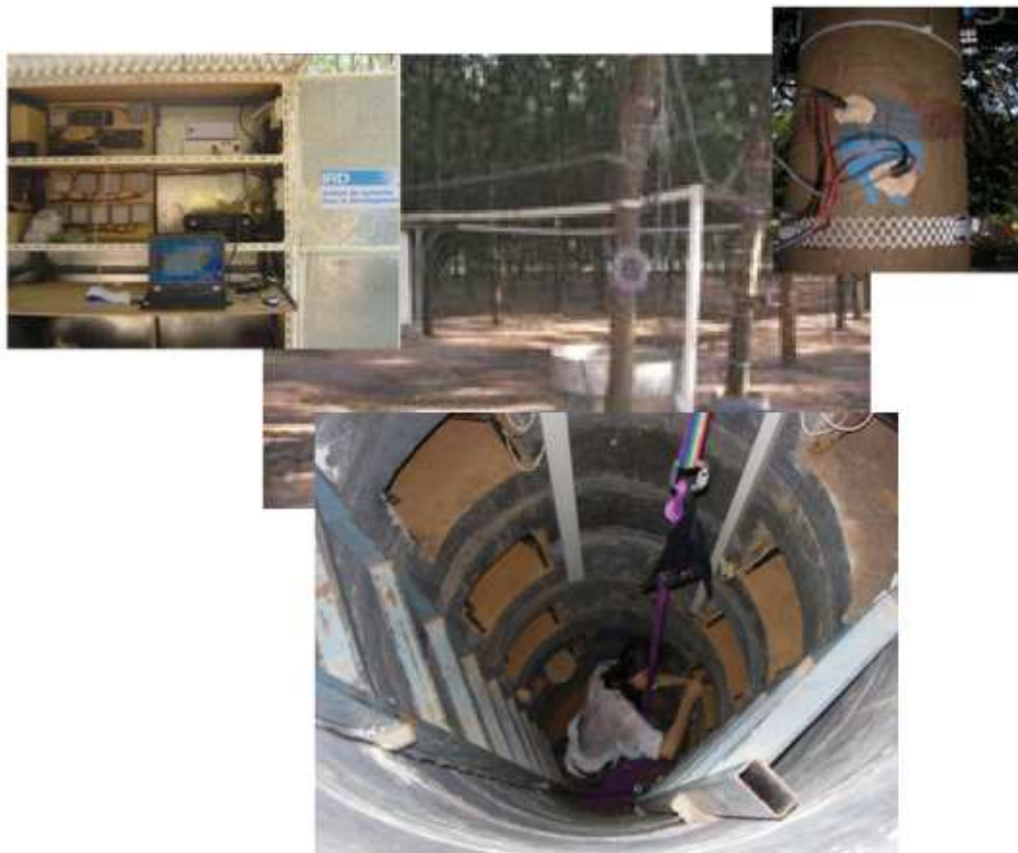
Photo 5: Dispositif d'acquisition de données dans le puits et des capteurs sur un hévéa
