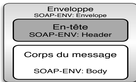
FIGURE 2.1 – Structure d'un message SOAP
