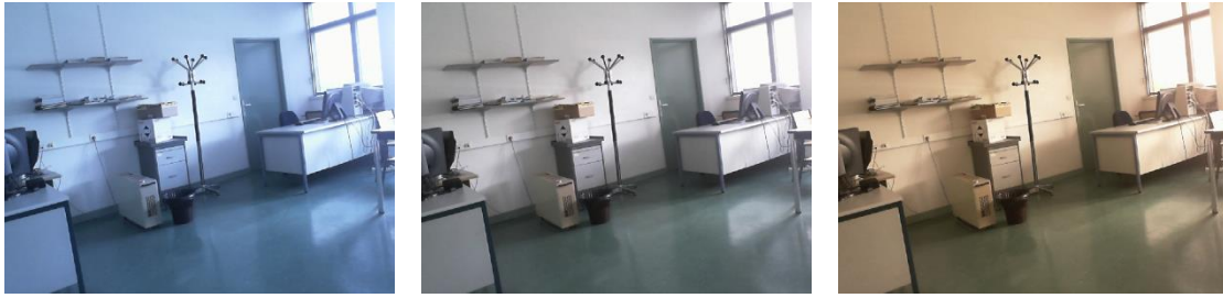
FIGURE 3.3 – Effet de la balance des blancs sur une même scène. Dans ce cas particulier, la scène présente une couleur dominante qui tend vers le bleu lorsque la balance des blancs est réglée à des valeurs faibles (figure de gauche). La figure du milieu présente la même scène lorsque la balance des blancs est réglée à une valeur moyenne, rendant ainsi une capture dont les tons se rapprochent de ce que nous percevons naturellement. La figure de droite présente la scène lorsque le paramètre est réglé à une valeur plus importante, laissant apparaître une couleur dominante qui tend vers l'orange.
