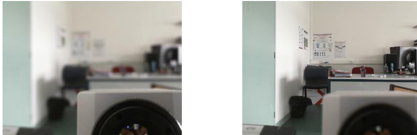
FIGURE 3.5 – Mise au point d'une webcam. La caméra peut se focaliser sur les objets proches (figure de gauche) ou sur les éléments plus lointains (figure de droite) selon la valeur de mise au point paramétrée. Cette dernière est ici contrôlée manuellement.
