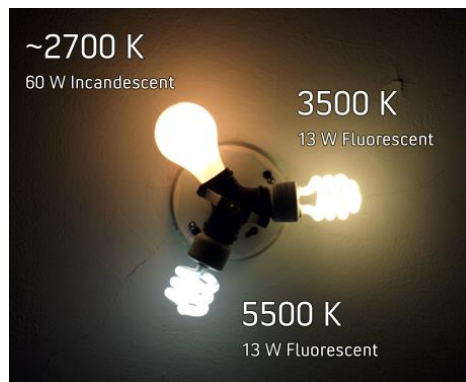
FIGURE 3.4 – Source lumineuse et température de couleur. Toutes les ampoules ne délivrent pas le même type de lumière [152].
