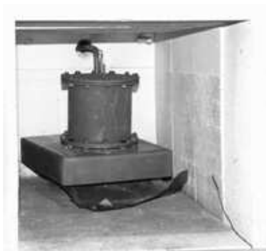
Figure III- 4 : Cellule de mesure de la conductivité thermique des poudres en place dans le four.
