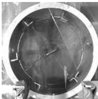
Figure I- 18 : Maquette COGEMA munie de quatre relevateurs corrodés ( Z = 6\% ).
