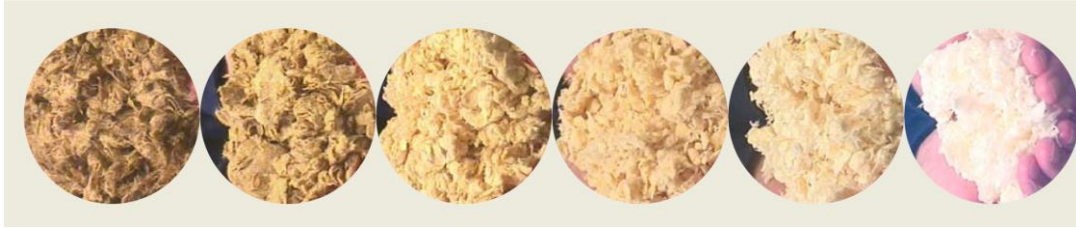
Figure 8 : Différentes étapes de blanchiment de la pâte à papier (publicationpapers.sca.com)
