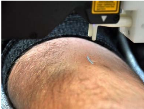
Figure 30 : (a) Dispositif d'indentation sans contact pour un essai sur l'avant-bras, (b) Schéma de principe du dispositif d'indentation sans contact : (1) le dispositif laser, (2) l'arrivée d'air, (3) la sortie d'air, (4) le jet d'air envoyé sur la peau, (5) la surface de la peau et (6) la ligne laser projetée sur la surface de la peau.
