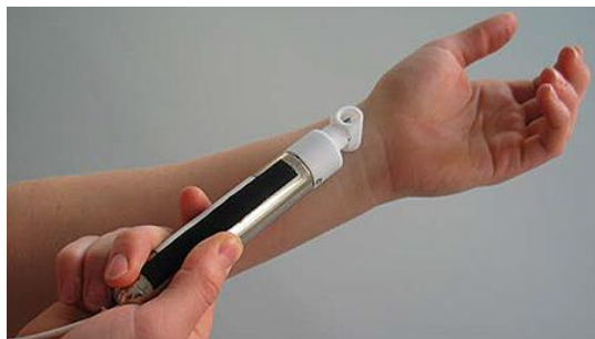
Figure 61 : Dispositif de mesure de la perte insensible en eau : le Tewamètre TM300
