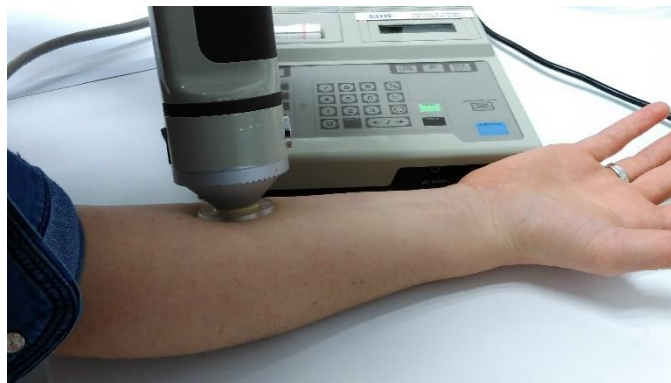
Figure 63 : Chromamètre Minolta CR-300
