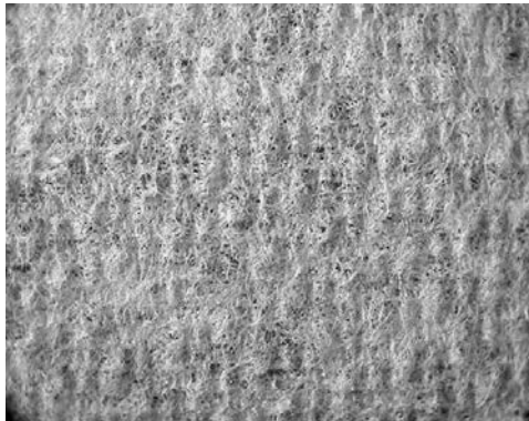
Figure 11 : Feuille de papier issue du procédé TAD, vue de dessus au MEB
