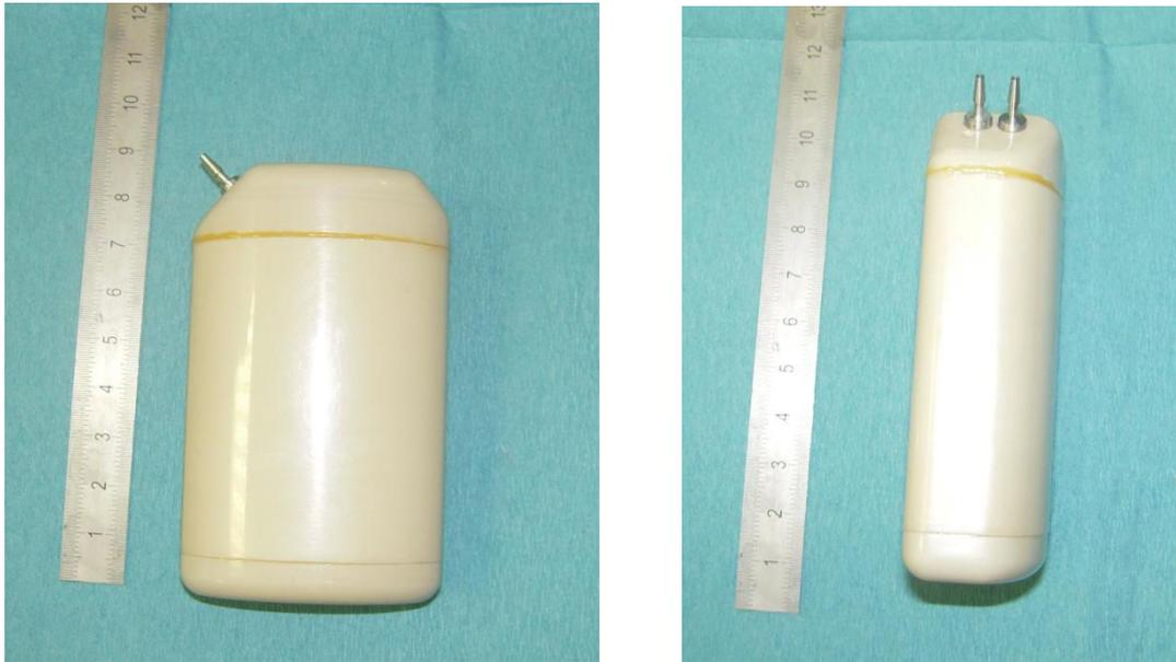
Figure 44 : photographie du boitier N°2 (pompe) de profil à gauche, de face à droite avec une entrée recevant le colorant du réservoir et une sortie vers le cathéter.
