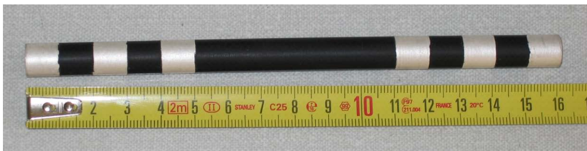
Figure 3.1 : Photo de l'amenée de courant \text{Bi}_{1.8}\text{Pb}_{0.26}\text{Sr}_2\text{Ca}_2\text{Cu}_3\text{O}_{10+x} étudiée.
