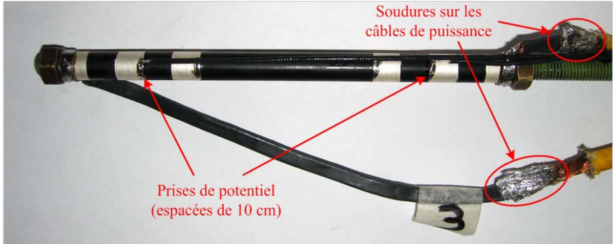
Figure 3.9 : Photo de l'amenée de courant \text{Bi}_{1.8}\text{Pb}_{0.26}\text{Sr}_2\text{Ca}_2\text{Cu}_3\text{O}_{10+x} avec ses prises de potentiel.
