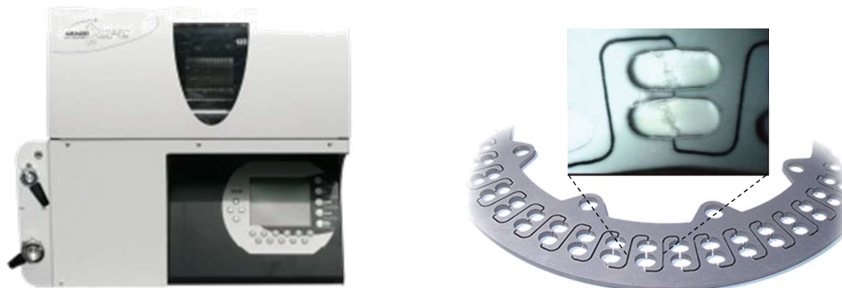
Figure 77 : Photographie d'un appareil CPC (Armen® instruments) et détail d'un des disques constitutifs de la colonne
