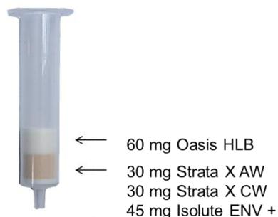
Figure 31 : Cartouche SPE multicouche fabriquée au laboratoire
