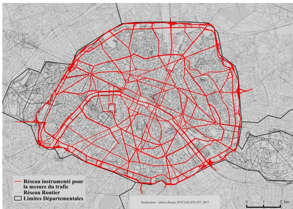
Figure 7.2.1 – Réseau instrumenté par des stations de comptage de trafic à Paris (Source : open data , Ville de Paris, 2017)
