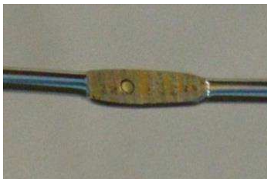
Figure III-2. Photographie du filament de tungstène-platine utilisé pour la chauffe. La microsphère de résine est initialement fixée dans le trou central.
