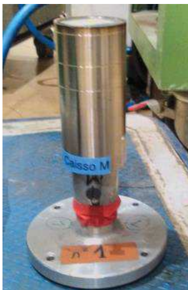
Figure IV-12. Vue extérieure du porte-échantillon en acier contenant 2,6 g d' U_{0,85}Am_{0,15}O_{2\pm\delta} sous forme de pastilles frittées, avant son installation sur la ligne de diffraction 3T2 du réacteur Orphée au CEA Saclay.
