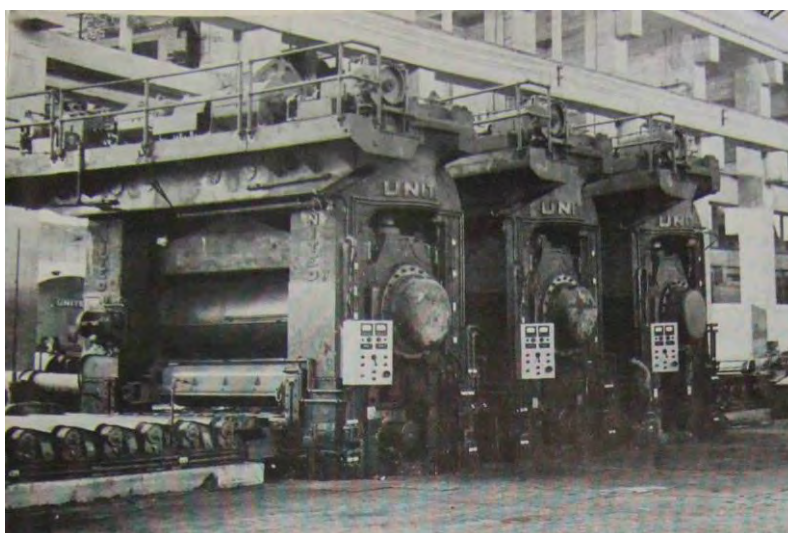
Figure 7 : Train continu à trois cages à chaud, L'usine de la Société Centrale des Alliages Légers , Rio Tinto France, Archives Pechiney. Collection historique, Direction Générale, cote 001-16-20502
