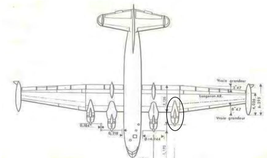
Figure 1.4 : Schéma situant la zone de prélèvement de la tôle L8 (Notice descriptive et de fonctionnement de l'avion Breguet 765 – Partie Planche – Fonds Ailes Anciennes Toulouse)
