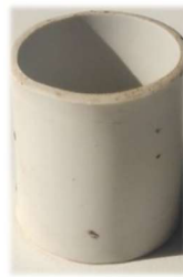
Figure II. 22 : Cylindre plastique pour la mise en forme de l'échantillon
