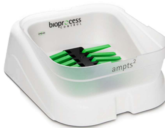
Figure II. 11 : Unité de mesure du volume de CH_4 du système AMPTS II lors de l'ouverture d'un clapet (situé en haut à droite)
