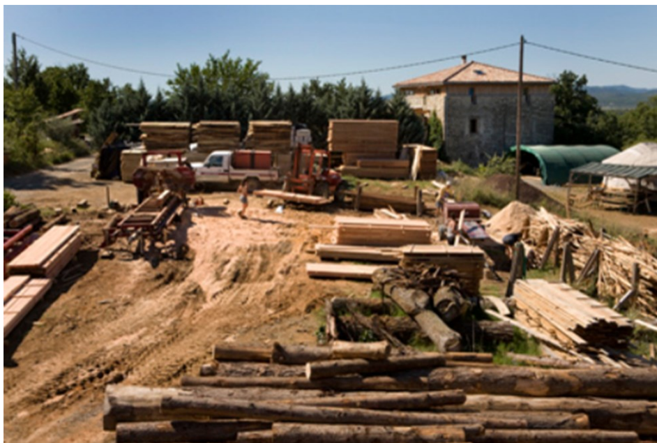
Photographie 41. La scierie mobile installée sur le chantier du Hameau des buis (© Hameau des buis)
