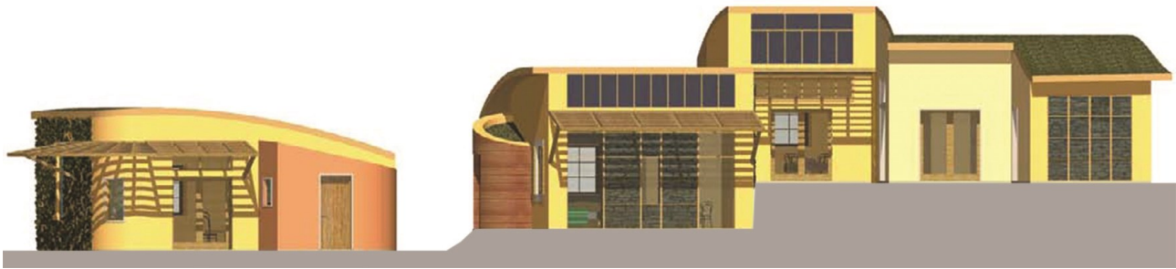
Façade 1. Conception bioclimatique des façades du Hameau des buis conçues pour capter l'énergie solaire : grandes baies vitrées, brise-soleil, panneaux thermiques, finalement installés en toiture (© Pierre-Henry Gomez architecte)
