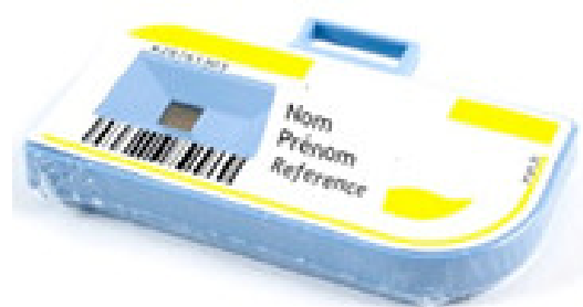
Dosimètre RPL référence pour le suivi radiologique des travailleurs en contact avec des rayonnements ionisants
