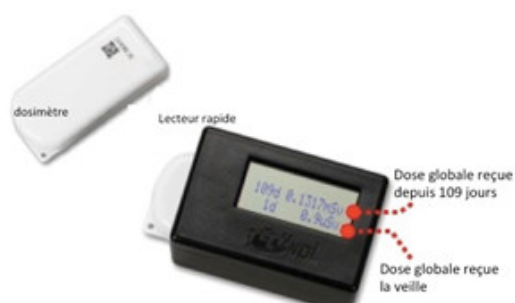
Dosimètre D-Shuttle fourni aux habitants de la région de Fukushima
