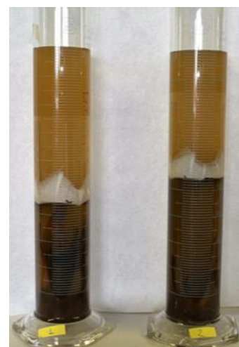
Figure 39 : Eprouvette graduée utilisée pour la détermination de la masse volumique réelle du bois broyé.
