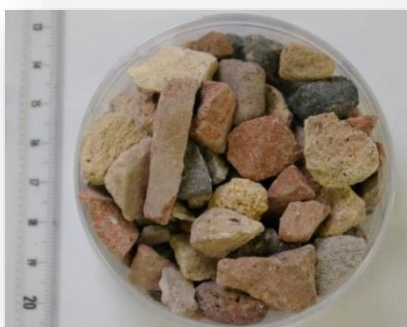
Briques et tuiles concassées
