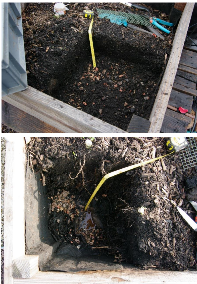
Figure 35 : Photo d'une zone (35*35 cm) de prélèvement sur deux bacs différents avec un horizon inférieur en brique. A gauche, la couche supérieure a été retirée. A droite, l'intégralité du Technosol a été retiré jusqu'au bas de l'horizon drainant. Photo prise en novembre 2016 lors de prélèvement au bout d'un an sur les Technosols du dispositif n°3. ©Grard Baptiste.
