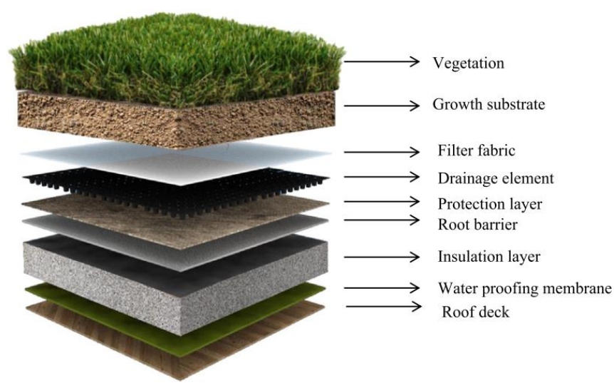
Figure 5 : Représentation schématique des différentes couches d'une toiture végétalisée. Issu de (Vijayaraghavan 2016).
