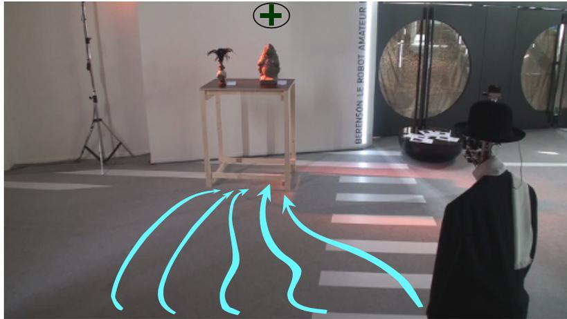
FIGURE 4.13 – Trajectoires (Hotel d’agglomération Futur En Seine 2012) du robot en partant de différents points. Les deux objets sur la table sont appris, à droite en positif et à gauche en négatif.
