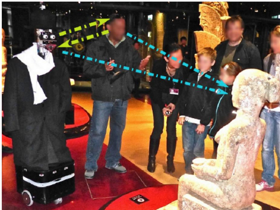
**FIGURE 3.6** – Le robot "berenson" au musée du Quai-Branly durant une interaction triadique (Visiteur-Oeuvre-Robot). Le visiteur apprend au robot à reconnaître la statue en avant plan en lui associant une valence positive. Le robot est guidé par le visiteur en utilisant un joystick. Pendant cet apprentissage, le visiteur prend la place du médiateur de l'expérience et explique à d'autres visiteurs l'objet de la manifestation et la manière avec laquelle il participe à l'éducation du robot.
