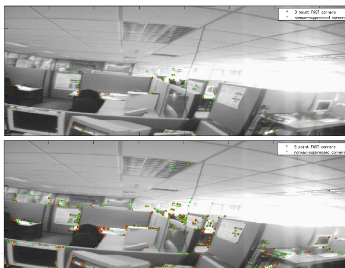
FIGURE 7.10: Détection de points d'intérêts sur des images expérimentales avec un seuil =50, 30
