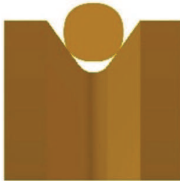
Figure 4 : Zoom sur le contact ponctuel entre la gorge de la bague et le fil (2 points de contact par fil).
