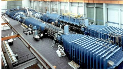
FIG. 1.9 – Vue de dessus du Grand Tunnel Hydrodynamique [10].
