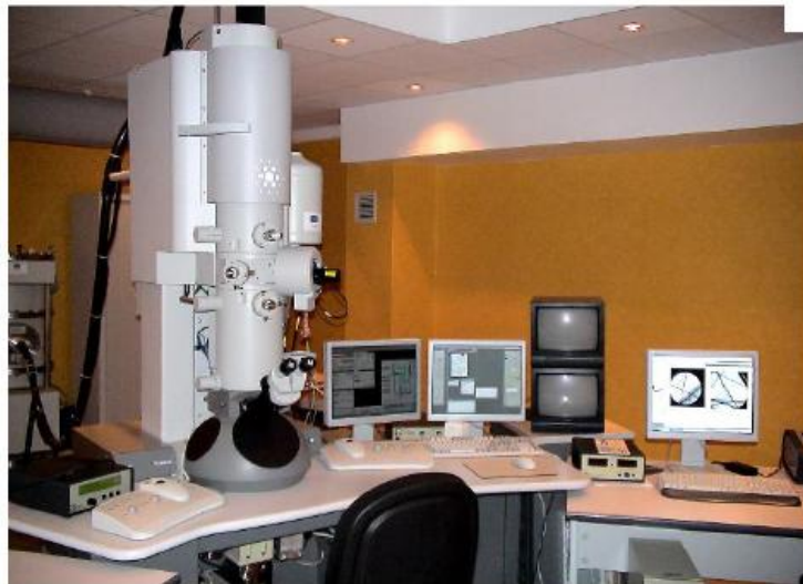
Fig. II.11. Schéma d'un Microscope Electronique en Transmission.
