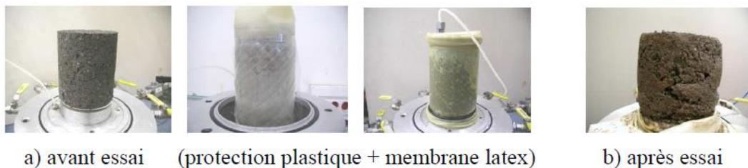
**Figure I.9.** Echantillons de MIDND avant et après test triaxial [BEC 07]
