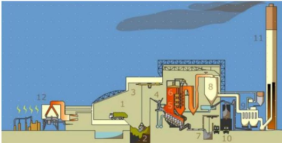
**Figure I.1.** Principe de fonctionnement d'une UIOM
