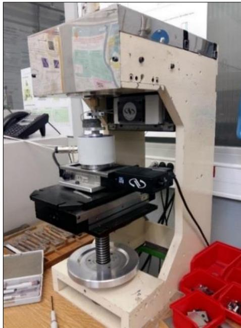
*Figure I.23. Appareil d'indentation utilisé (Equipements PSM-LGCGM INSA Rennes)*
