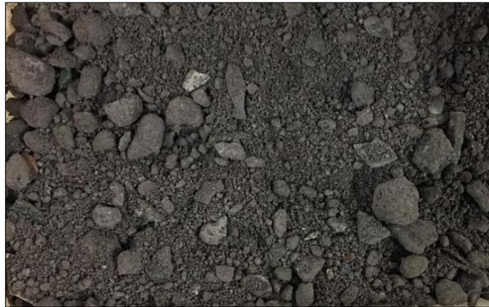
*Figure I.14. MIDND 0/25 mm provenant des carrières de la Garenne*
