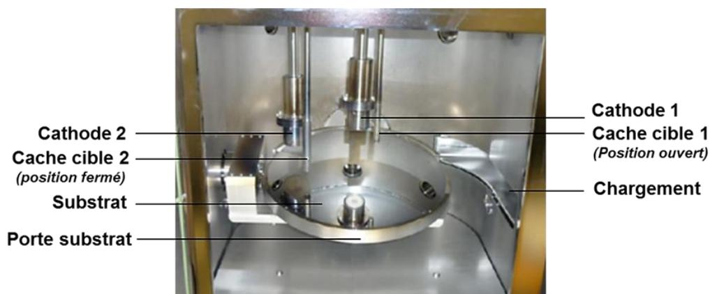
Figure III-6 : Intérieur de l'enceinte de dépôt
