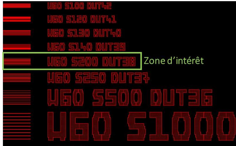
**Figure V-3 :** Description d'une partie de la lithographie du masque MUST utilisé. La zone d'intérêt choisie est « W60 S200 DUT38 » (entourée en vert)
