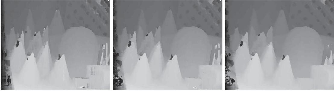
**Figure 3.6** – Images de disparité obtenues par méthode SGM en prenant en compte 4, 8 et 16 directions. Le modèle est le même que dans la Figure 3.5. En comparaison, la solution devient plus lisse à mesure que le nombre de directions prises en compte augmente. Cela permet de réduire les artefacts de la méthode, mais détériore la reconstruction des objets fins.
