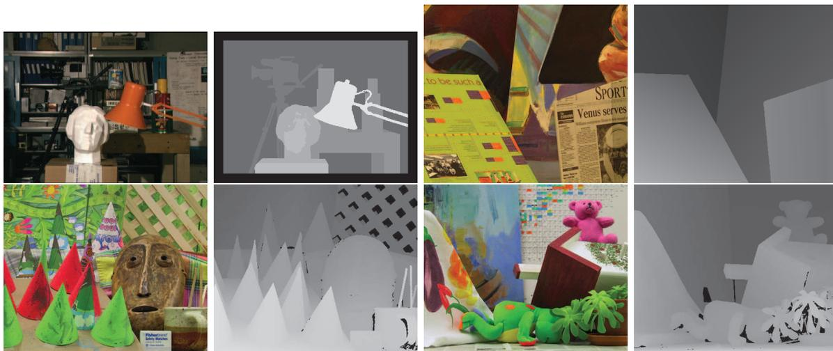
**Figure 2.12** – Couples d’image de la base de test et la vérité de la carte de disparité dans la géométrie de l’image gauche. De gauche à droite et de haut en bas, le couple Tsukuba et les couples Venus, Cones et Teddy de la base Middlebury.
