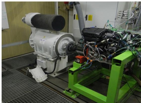
**Figure II-31:** Banc d'essai Diesel DV6 du laboratoire PRISME
