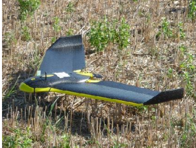
Figure 5.1 : Drone eBee (Sensefly). Aile volante propulsée par une hélice (© B. Millescamps)
