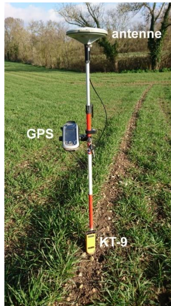
Figure 2.3 : Susceptibilimètre KT-9 ( Kappameter ) et le GPS différentiel ( Spectra Precision ).
