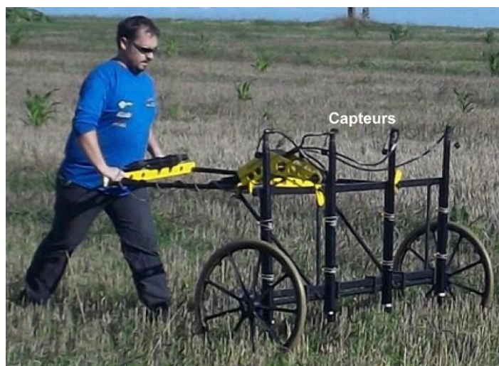
Figure 2.1 : Gradiomètre FEREX (Foerster Institut) avec quatre capteurs de type fluxgate montés sur son chariot (©A. Camus).
