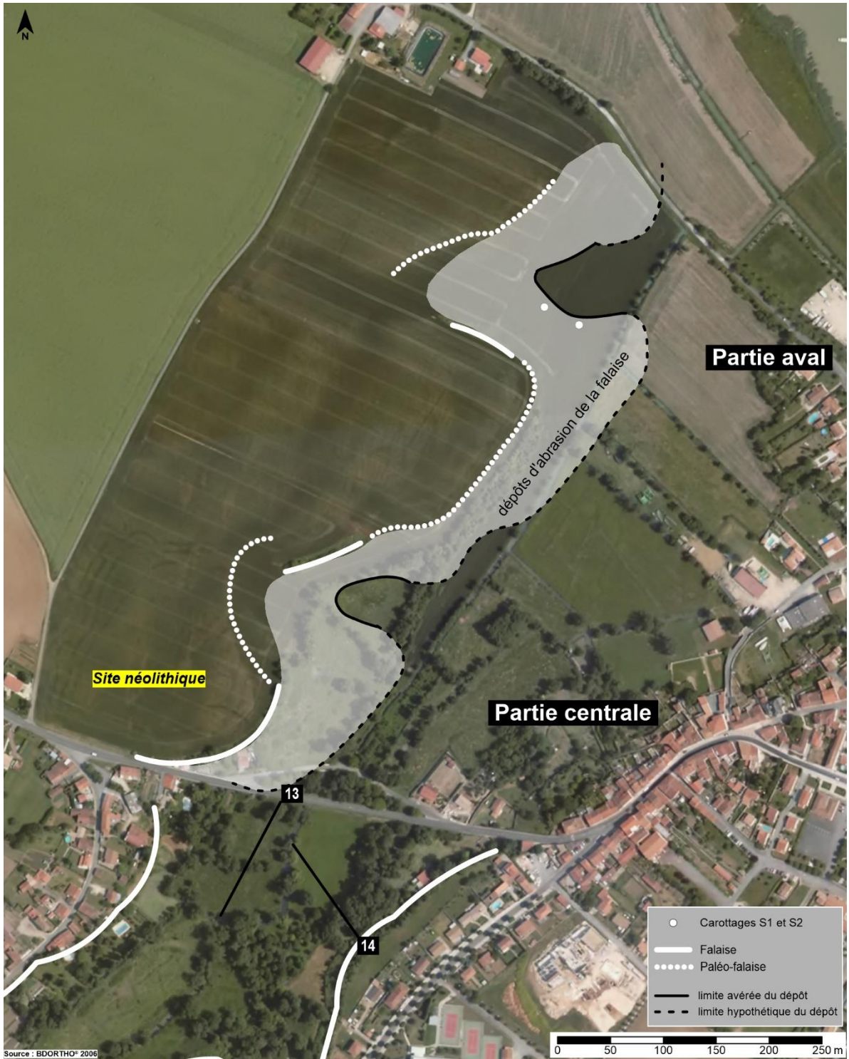
Figure 1.19 : Hypothèse de l'extension du dépôt d'abrasion de la falaise réalisée à partir de la synthèse de la carte de conductivité apparentent, des sections électriques et des carottages de Soubise 1 et 2.
