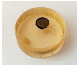
Figure III.33 : Pièce SiC-Ti-1 polie puis enrésinée pour l'analyse EBSD
