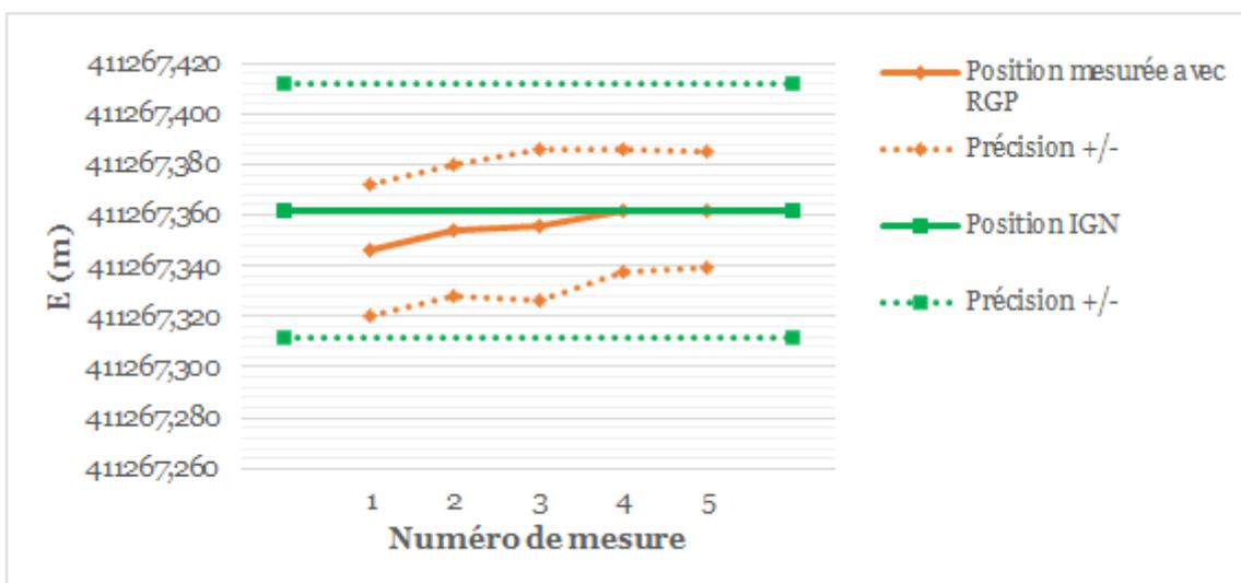
Figure A1.1. Évolution en mètres de la composante est (E) du point de référence PR reportée dans le système RGF93 Lambert 93. Vérification de la stabilité de PR par rapport à la position annoncée par l'IGN.
