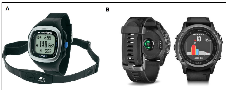
Figure 10 : Exemple de deux modèles de cardiofréquencemètre utilisant une technologie différente. En A la RUNGPS1 (Runtastic), mesure la FC à partir d'électrodes situées sur une ceinture thoracique et en B, la Fenix 3 HR (Garmin), mesure la FC au niveau du poignet via un capteur optique (LED verte).
