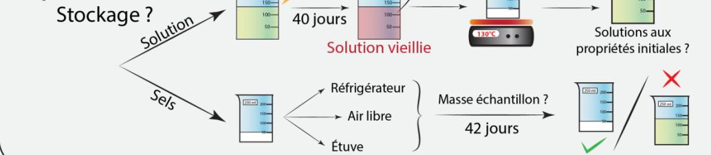
Fig. 51. Objectif et principales étapes du protocole de tests sur l'iodure de sodium (NaI).
