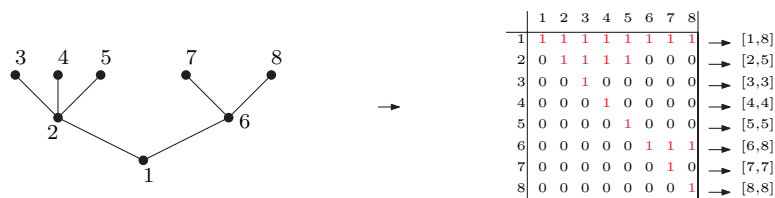
FIGURE 1.5: Matrice d'adjacence d'un arbre dont les éléments sont en ordre préfixe
