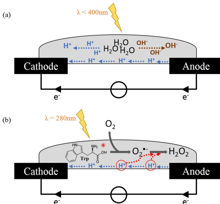
**Figure C.41** : Schémas représentant les mécanismes hypothétiquement responsables des variations de courant observés sous illumination des échantillons dans le proche UV : (a) effet d'augmentation du courant et (b) effet de diminution du courant.
