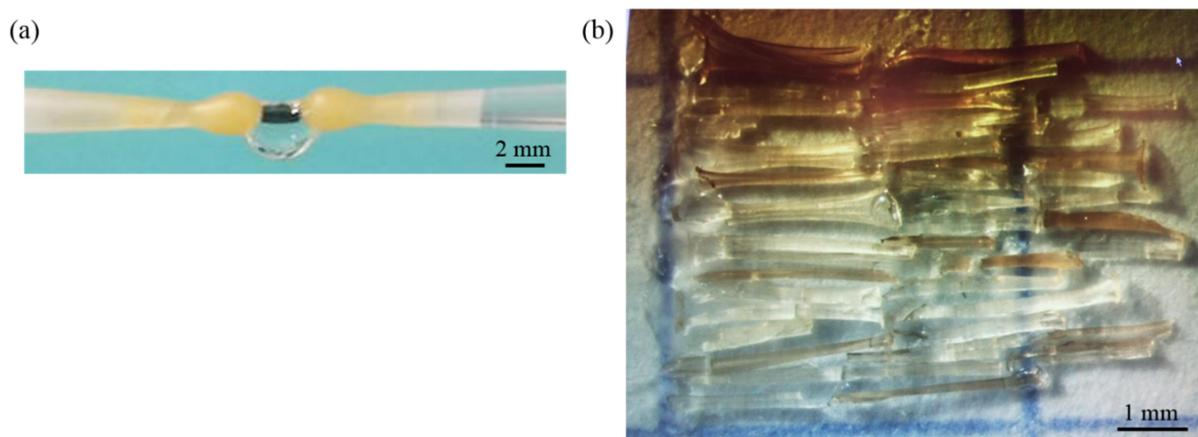
**Figure B.8** : (a) Goutte d'échantillon de fibres HET suspendue entre deux pointes recouvertes de cire. En séchant, les fibres s'alignent et un fagot solide de fibres aligné est formé. (b) Plusieurs fagots de fibres HET alignées collées sur une feuille de mica pour les expériences de diffusion des neutrons.
