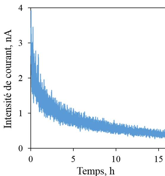
**Figure C.5** : Exemple d'une mesure courant-tension ( $I-t$ ) enregistrée pour un film de fibres HET à une tension de polarisation égale à 3 V et à température et humidité stable ( $T = 30\text{ °C}$  ; HR = 55 %).
