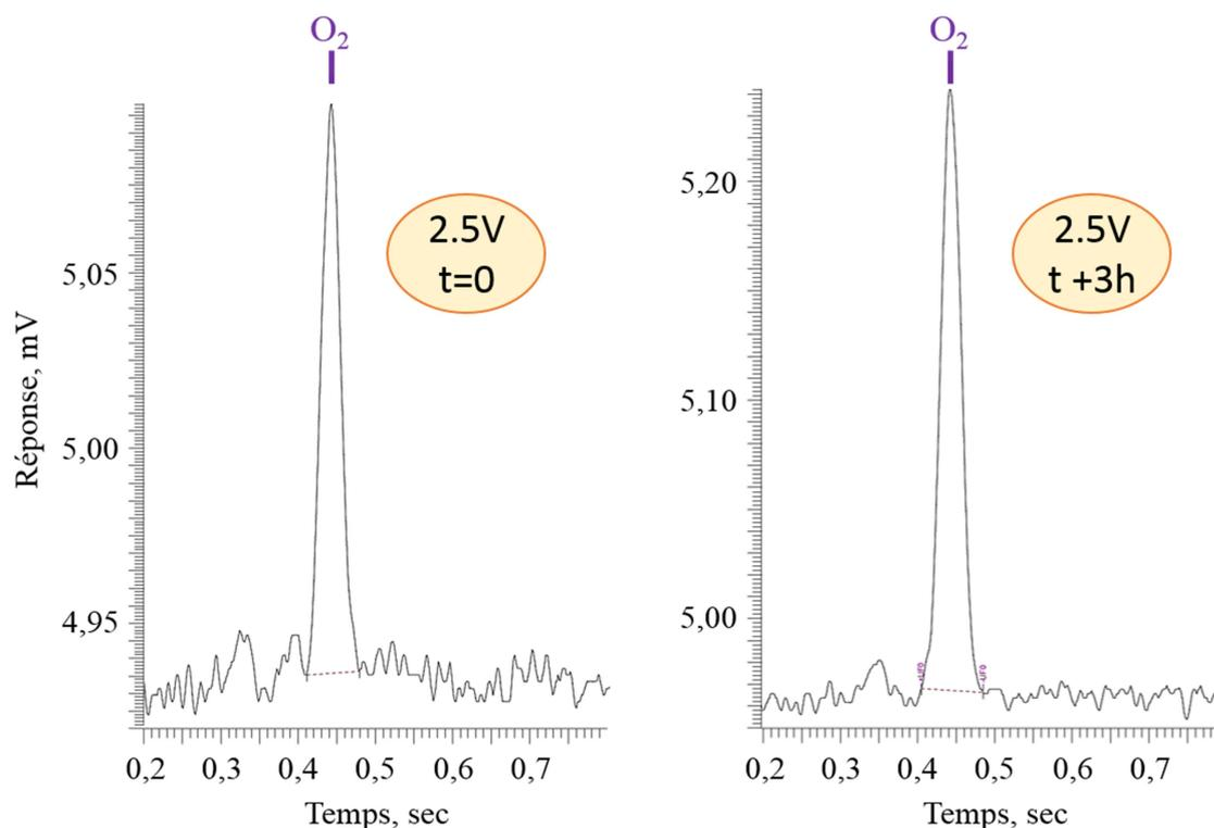
**Figure C.12** : Analyses de chromatographie en phase gazeuse au cours de la polarisation continue d'un film de monomères HET à 2,5V. Aucun autre gaz que l'O<sub>2</sub> résiduel après l'étape de dégazage (**Figure C.11, haut**) n'est détecté.
