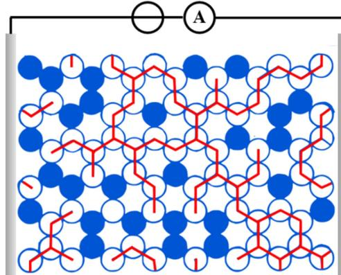
**Figure A.17** : Illustration de la théorie de la percolation dans un système composé d'éléments conducteurs (ronds vides) au sein d'une matrice isolante (ronds pleins). L'augmentation du nombre d'éléments conducteurs permet l'extension des voies de percolation (en rouge) via lesquelles des charges peuvent être transférer entre les deux électrodes.
