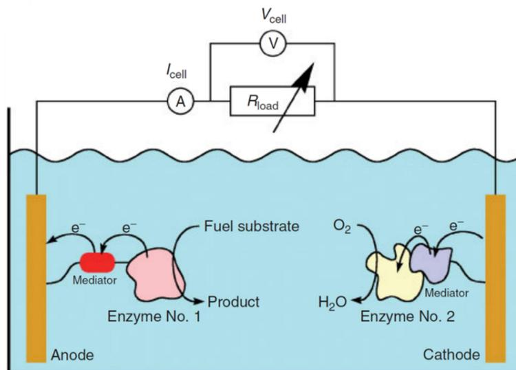
**Figure A.5** : Schéma expliquant le principe de fonctionnement d'une biopile enzymatique
