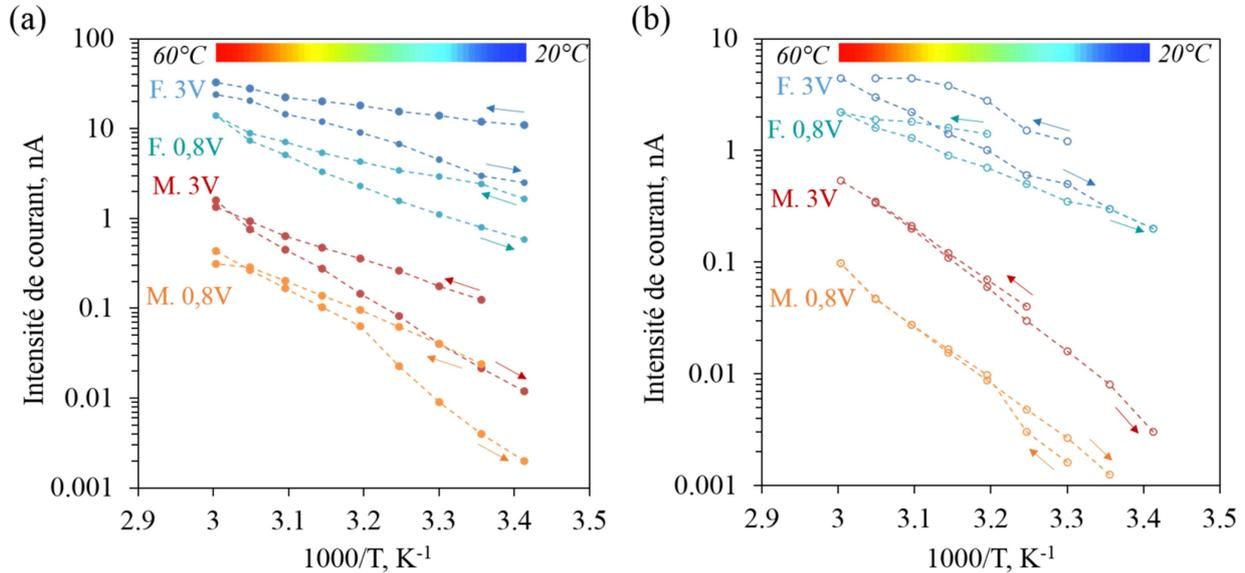
**Figure C.8 :** Effet de la température entre 20 et 60°C sur la conductivité des films de monomères (M, courbes rouges) et de fibres (F, courbes bleues) HET avec une HR stable de 80% (a) et 60% (b) et une DDP fixée dans le 1<sup>er</sup> régime (0,8V) ou le 2<sup>nd</sup> régime (3V) de conduction des fibres.
