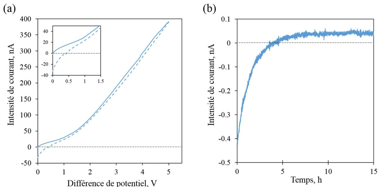
**Figure C.4 :** (a) Deux mesures successives de la caractéristique  $I$ - $V$  d'un même film de fibres HET. Un effet capacitif à basse tension  $< 0,5$  V (encart). Cet effet est également observé pour les  $I$ - $V$  obtenus avec les films de monomères. (b) Effet capacitif d'un film de fibres HET. Une décharge progressive de courant est enregistrée (DDP = 0V) après polarisation du film à 3V (conditions de température et d'humidité stables).
