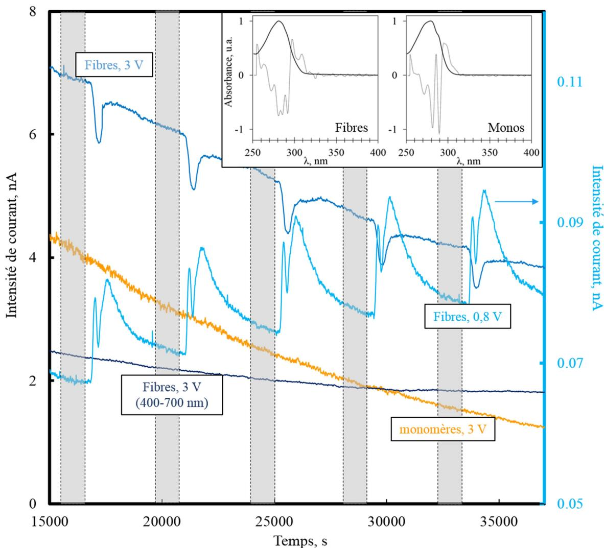
**Figure C.28** : Mesure  $I-t$  pour un film de fibres HET (courbes bleues) et pour un film de monomères (courbe orange). Les périodes d'illumination (balayage en longueurs d'onde de 200 à 700 nm à  $10 \text{ nm}\cdot\text{min}^{-1}$ , sauf précision contraire) sont sur fond blanc et périodes sans illumination sur fond gris. Encart : spectres d'absorption des fibres et monomères HET entre 250 et 400 nm (courbe noire) et leur dérivée seconde (courbe grise).
