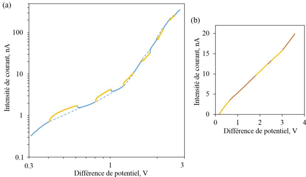
**Figure C.30** : Effet de la lumière à 280 nm sur la caractéristique  $I-V$  (a) des fibres HET et (b) des monomères HET. Les courbes sont marquées en jaune lors des périodes d'exposition à la lumière.
