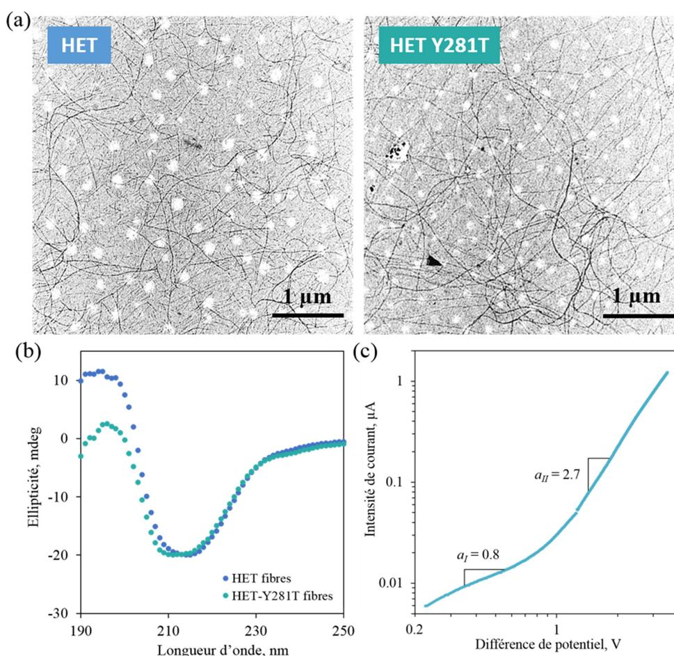
**Figure C.35** : (a) Clichés de microscopie électronique en transmission (TEM) de fibres amyloïdes HET (gauche) et HET-Y281T (droite). (b) Spectres de dichroïsme circulaire (CD) des fibres HET (bleu foncé) et HET-Y281T (bleu claire). (c) Caractéristique  $I$ - $V$  des fibres HET-Y281T en représentation doublement logarithmique.
