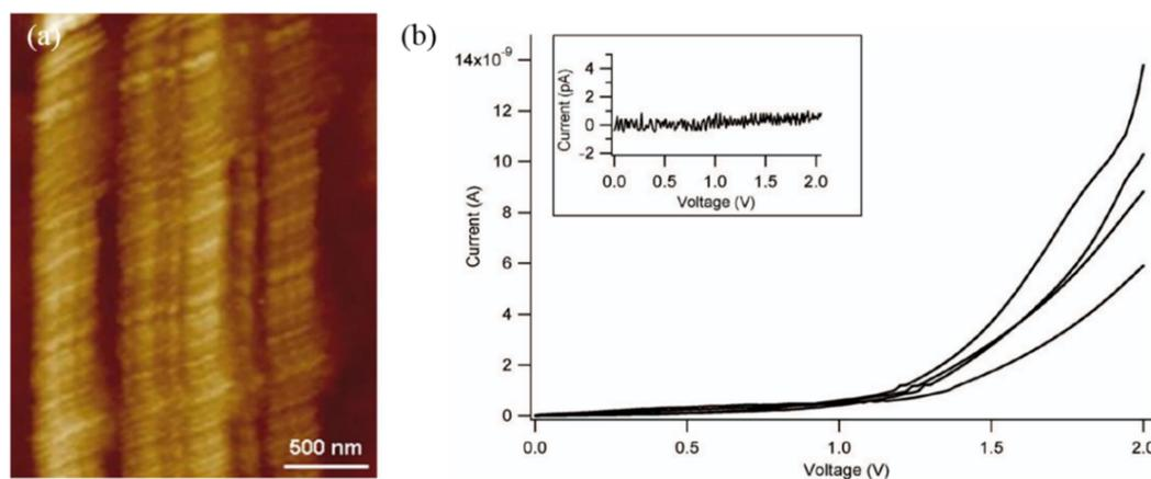
**Figure A.20** : (a) Image de microscopie à effet tunnel de fibres de protéines formées par le peptide poly(VGGLG) déposées sur un substrat en or et (b) caractéristique  $I-V$  typiques de ces fibres déposées sur des électrodes d'or inter-digitées. La mesure contrôle du dispositif vide est montrée en insert.
