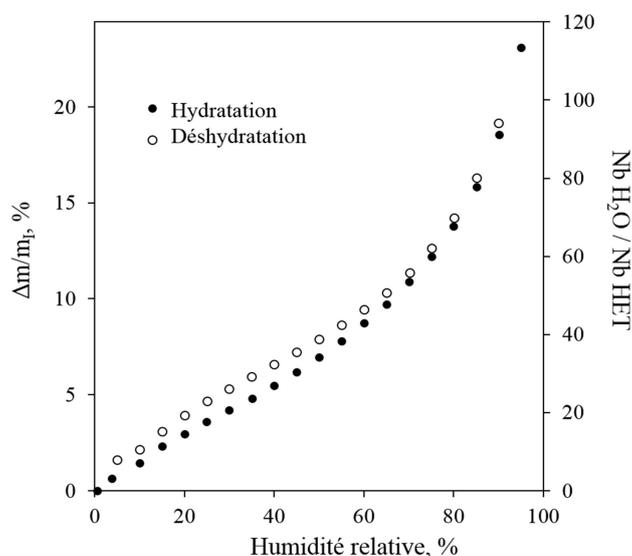
**Figure C.15** : Isothermes d'adsorption et de désorption d'eau des fibres HET.
