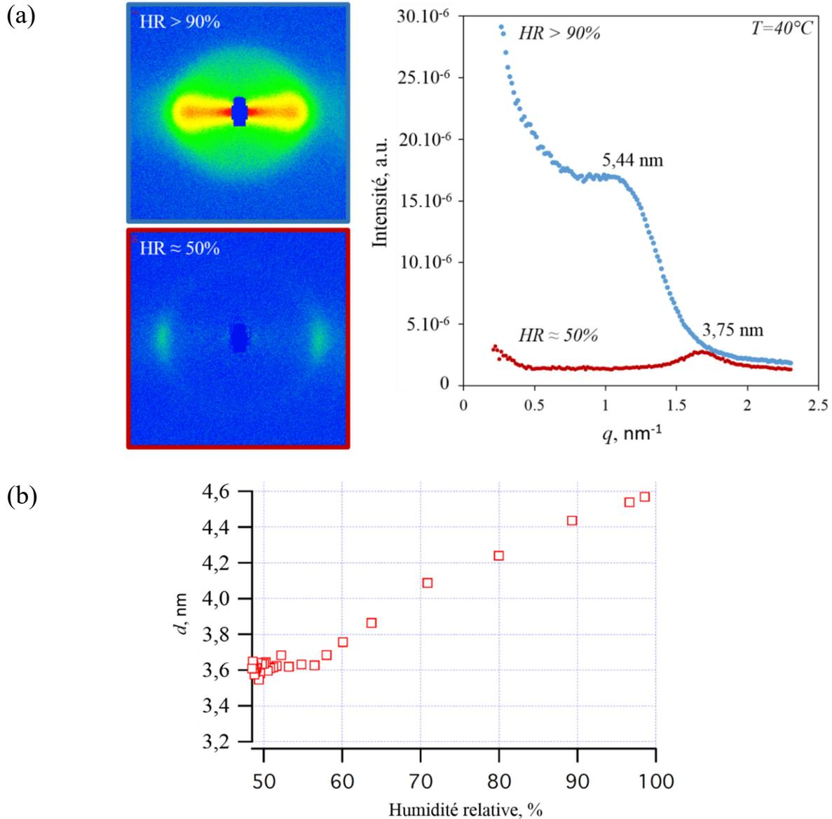
**Figure C.18** : (a) Clichés 2D et profils 1D (équatorial) SANS obtenus à haute (> 90% HR) et basse (50% HR) humidité (respectivement encadrés bleu et rouge et graphe bleu et rouge). (b) Evolution de la périodicité correspondante au pic détecté (figure (a)) en fonction de l'humidité de la chambre où est placé l'échantillon. La température est fixe = 40°C (a) = 25°C (b).
