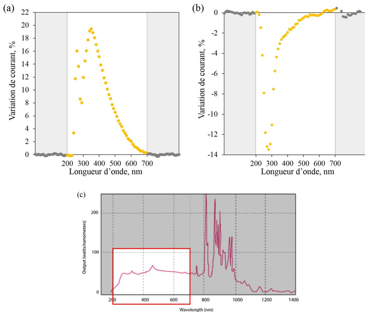
**Figure C.29** : variation moyenne du courant en fonction de la longueur d'onde d'illumination des films de fibres amyloïde HET, (a) dans le premier régime et (b) dans le second régime de conduction. Ces courbes ont été construites à partir du graphe *I-t* de la **Figure C.28**. (c) Spectre typique d'une lampe xénon. La gamme spectrale utilisée (200-700 nm) est encadrée en rouge.
