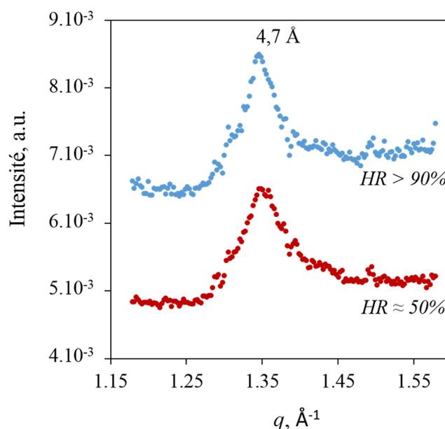
**Figure C.19** : profils 1D (méridional) obtenus à haute (> 90% HR) et basse (50% HR) humidité (respectivement en bleu et rouge). Les diffractogrammes correspondants ne sont pas montrés car les pics sont peu intenses donc peu visibles. La température est fixe = 25°C.
