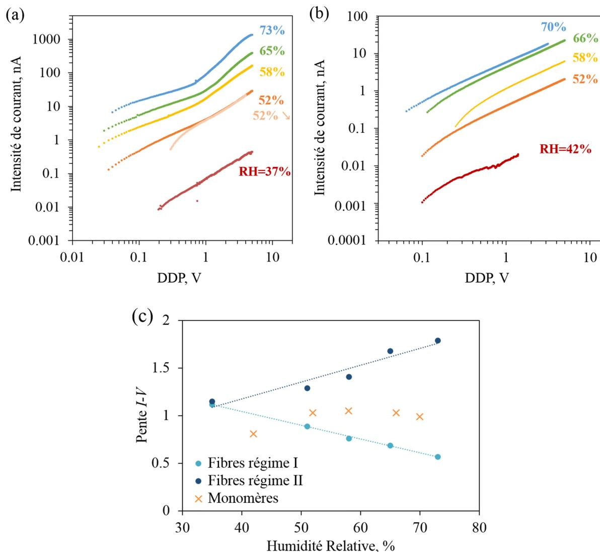
**Figure C.7 :** Effet de l’humidité sur les caractéristiques  $I-V$  des films de fibres (a) et de monomères (b). (c) variation des pentes de la caractéristique  $I-V$  des monomères (orange) et des fibres avec l’humidité (bleu, pente du 2<sup>nd</sup> régime de conduction et bleu clair, celle du 1<sup>er</sup> régime).
