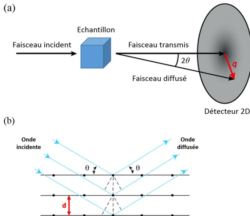
**Figure B.7 :** (a) Schéma présentant le principe d'une expérience de diffusion d'une radiation par un échantillon (b) Schéma représentant l'organisation des atomes (points) d'un matériau cristallin. Les atomes forment des plans espacés de la distance  $d$  selon lesquels l'onde incidente est diffusée avec un angle  $\theta$ . L'onde diffusée est détectée à une distance  $q$  du centre du détecteur 2D.
