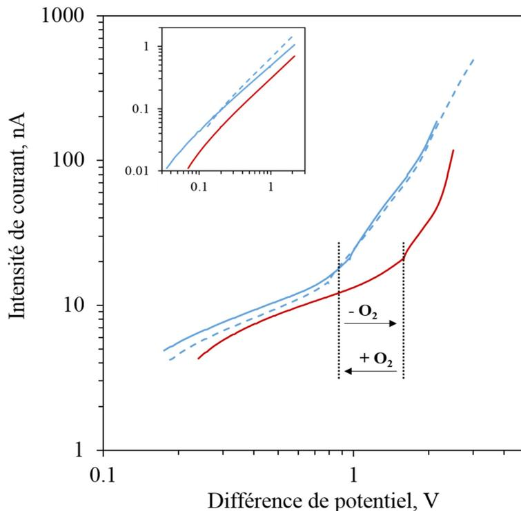
**Figure C.10** : caractéristiques  $I-V$  d'un film de fibres amyloïde HET et d'un film de monomères HET (encart) en présence ou absence d'oxygène. En bleu, les caractéristiques obtenues en présence d'oxygène (atmosphère air,  $O_2 = 21\%$ ), en rouge, en absence d'oxygène ( $O_2 < 0,1\%$ ) et en bleu pointillé de nouveau en présence d'oxygène, après les conditions anoxiques.
