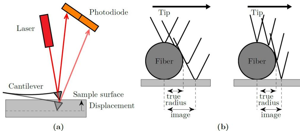
**Figure B.6 :** (a) Vue latérale schématisée de l'ensemble levier-pointe d'AFM avec le montage optique permettant l'analyse continue de la position de la pointe. (b) Schéma montrant l'importance du profilage de la pointe. Une image AFM réalisée avec une pointe de grand rayon de courbure (à gauche) présentera des artefacts grossissants les objets sondés plus importants qu'avec une pointe plus affinée (à droite).
