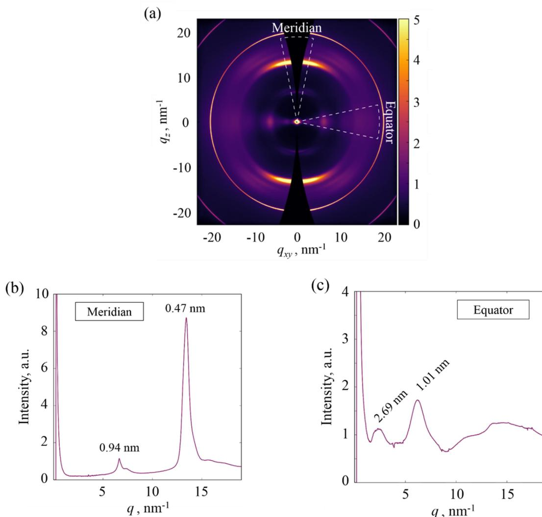
**Figure C.16** : Cliché 2D et profils 1D (équatorial et méridional) SAXS/WAXS de fagots de fibres HET obtenus sur la ligne ID13 à l'ESRF. (a) Les deux anneaux très fin et bien définis du cliché 2D sont imputables au sel résiduel dans l'échantillon. Quatre pics de Bragg sont attribuable à la structure des fibres, deux selon l'orientation méridionale (0,94 et 0,47 nm) (b) et les deux autres selon l'axe équatorial (2,69 et 1,01 nm) (c).
