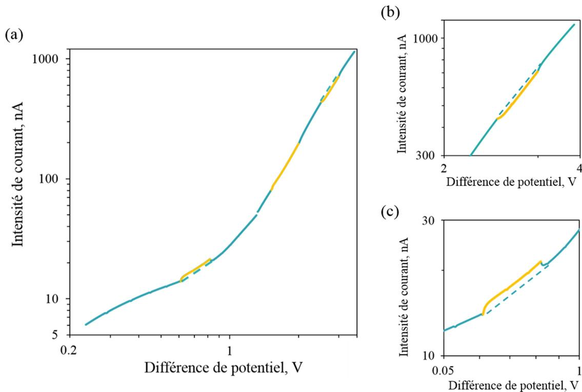
**Figure C.36** : Effet de la lumière  $\lambda = 280$  nm sur la caractéristique  $I$ - $V$  des fibres HET-Y281T. (b) et (c) Zoom de la courbe (a) montrant respectivement l'effet de diminution ou d'augmentation du courant dans le deuxième ou le premier régime de conduction. Les courbes sont marquées en jaune lors des périodes d'exposition à la lumière.
