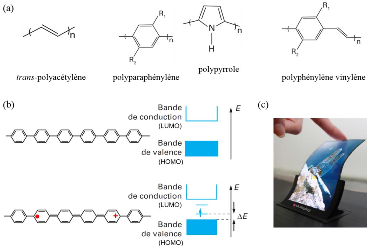
**Figure A.8** : (a) exemples de systèmes  $\pi$ -délocalisés : chaînes carbonées alternant simples et doubles liaisons, chaînes contenant des (hétéro)cycles aromatiques et chaînes alternant (hétéro)cycles et doubles liaisons. (b) Dopage d'un polymère neutre (polyparaphénylène) par injection de charge et représentation schématique de la structure en bandes correspondante. (c) Exemple d'écran flexible réalisé grâce à des OLEDs.
