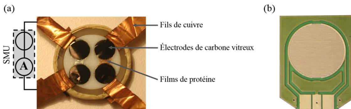
**Figure B.3** : Dispositif pour la caractérisation. (a) dispositif à 2 électrodes utilisé pour les mesures de conduction électrique. (b) électrodes interdigitées en or et de gap 150 µm pour la spectroscopie d'impédance électrochimique (EIS). Le peigne a une structure ronde de diamètre 15 mm.
