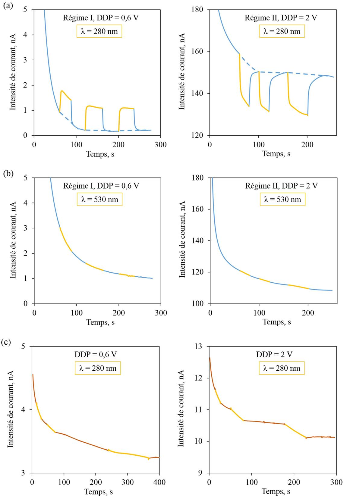
**Figure C.31** : Effet de la lumière sur la conductivité des fibres (a)  $\lambda = 280\text{nm}$ , (b)  $\lambda = 530\text{nm}$ , et (c) des monomères HET avec  $\lambda = 280\text{nm}$ , dans les deux régimes de conduction des fibres. Les courbes
