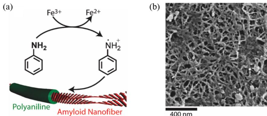
**Figure A.25** : Polymérisation de l'aniline sur des fibres amyloïdes de lysosyme. (a) Schéma du mécanisme proposé de la réaction de polymérisation. (b) Image de microscopie électronique à balayage (SEM) d'un film de fibres amyloïdes/polyaniline.
