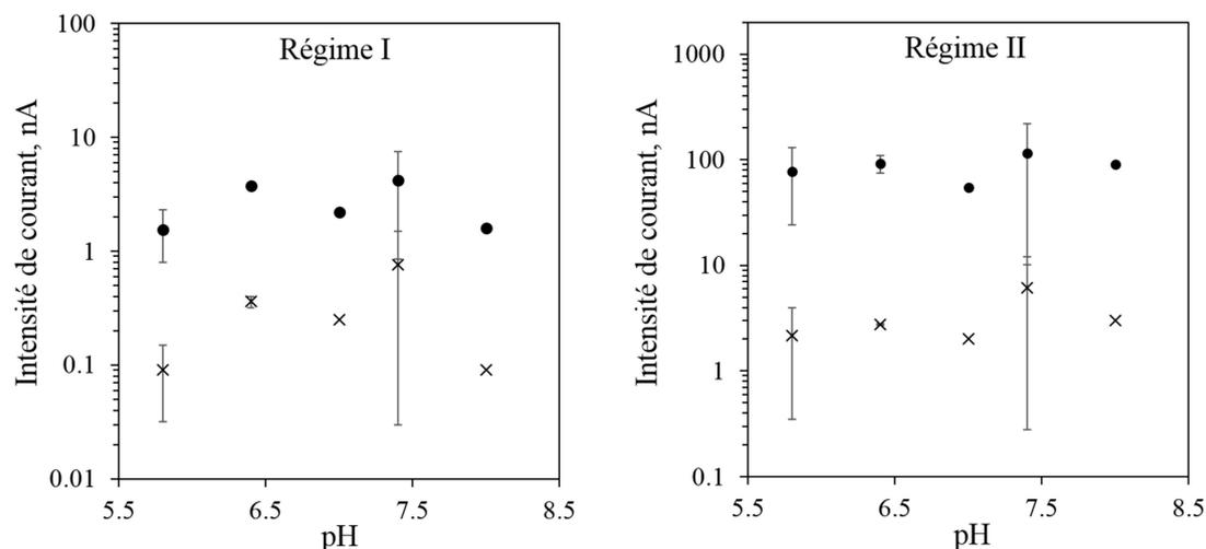
**Figure C.26** : Effet du pH sur la conduction des fibres HET dans les deux régimes de conduction. Les points correspondent au niveau de courant relevé à haute humidité (HR = 70 %) et les croix à "basse" humidité (HR = 50 %).
