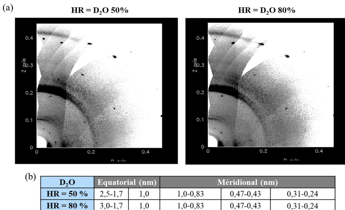
**Figure C.20** : Clichés 2D SANS de fagots de fibres HET obtenus sur l'instrument D19 à 50 (gauche) et 80 % (droite) d'humidité relative en atmosphère D<sub>2</sub>O. (b) Récapitulatif des distances correspondantes aux pics de Bragg. Seule la position du pic détecté aux plus petits angles selon l'axe équatorial (flèche en rouge) évolue avec l'humidité.
