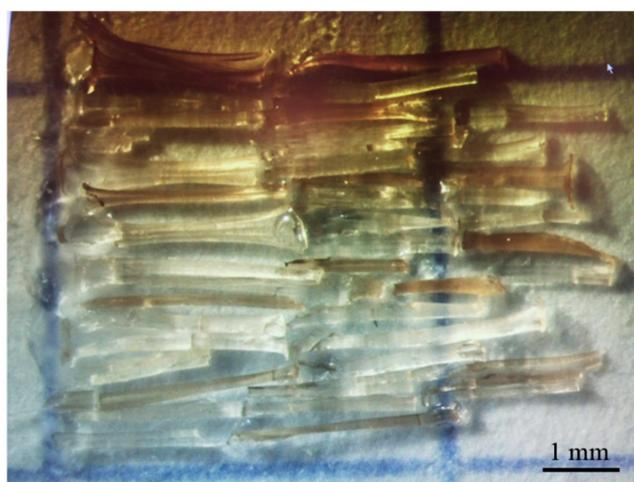
**Figure C.17** : Image montrant une partie de l'échantillon caractérisé par diffusion des neutrons : une centaine de "fagots" constitués de fibres HET alignées sont obtenus en séchant des gouttes d'échantillon ( $\sim 40 \mu\text{L} = 1$  fagot) entre deux pointes (cf. **Matériels et méthodes III.2.2.**) puis collés sur une feuille de mica en respectant le meilleur alignement possible.
