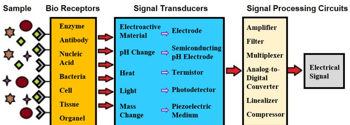
**Figure A.2** : Schéma du principe de fonctionnement des biocapteurs
