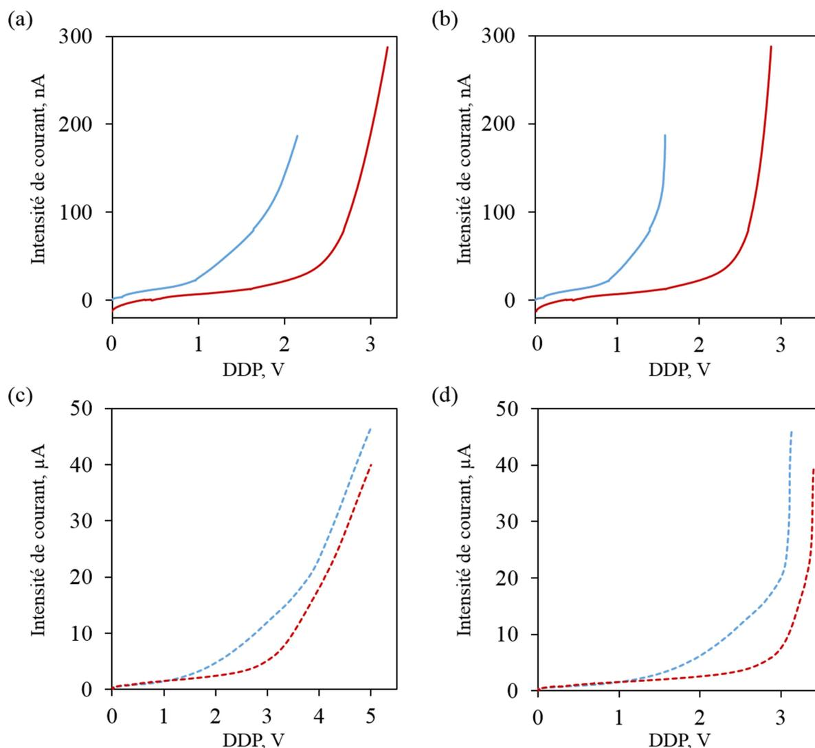
**Figure C.13** : Caractéristiques  $I-V$  (a) et caractéristiques avec une correction de chute ohmique (b) d'un film "sec" de fibres HET en présence et en absence d'oxygène (respectivement courbes bleues et rouges). La même expérience  $I-V$  est réalisée pour une goutte (restée liquide) d'HCl 100 $\mu$ M (c) et également représentée avec une correction de chute ohmique (d).
