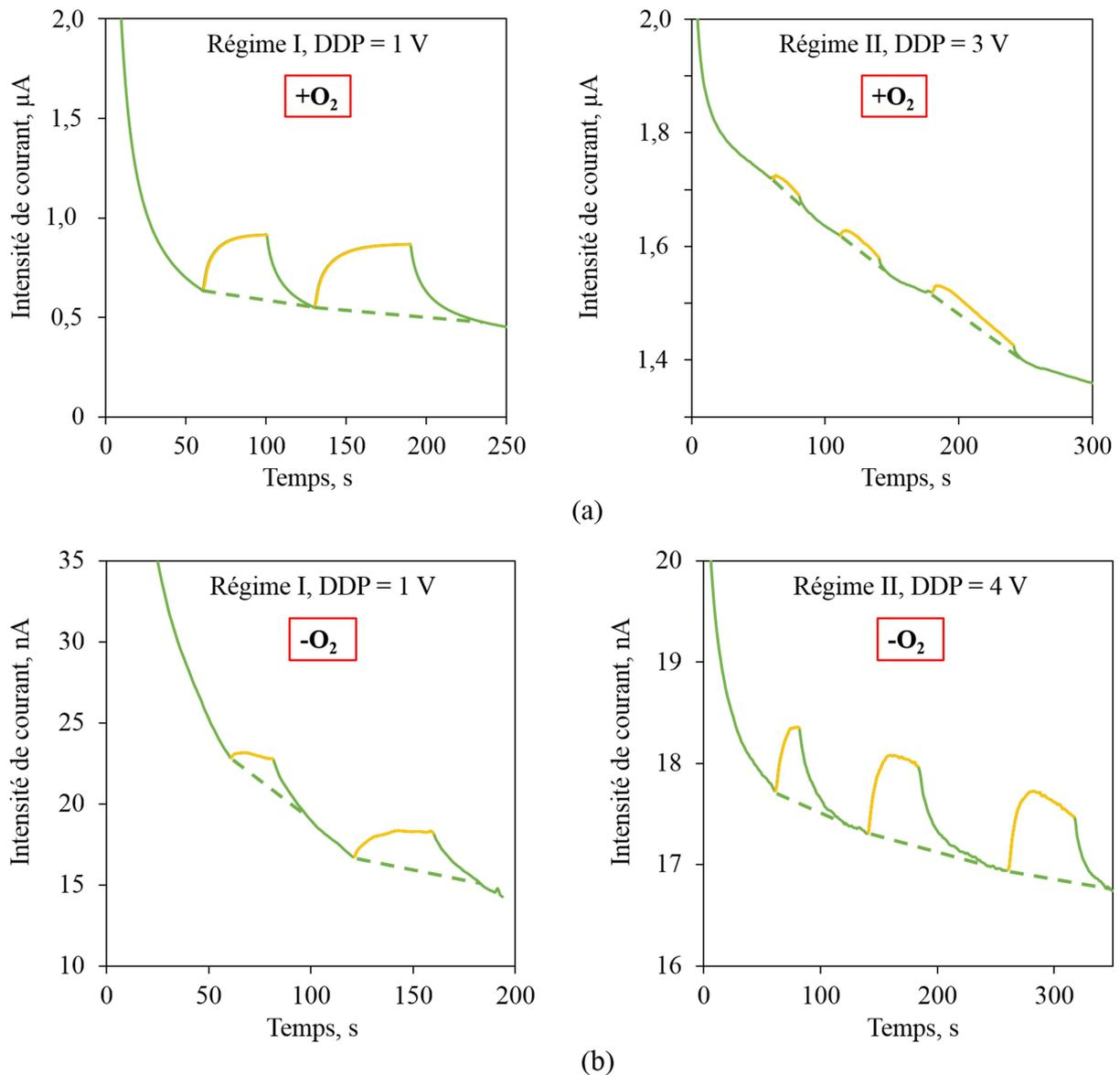
**Figure C.38** : Effet de la lumière  $\lambda = 280\text{nm}$  sur la conductivité des fibres R2T (a) en présence d'oxygène et (b) en absence d'oxygène, dans les deux régimes de conduction. Les courbes sont marquées en jaune lors des périodes d'exposition à la lumière.
