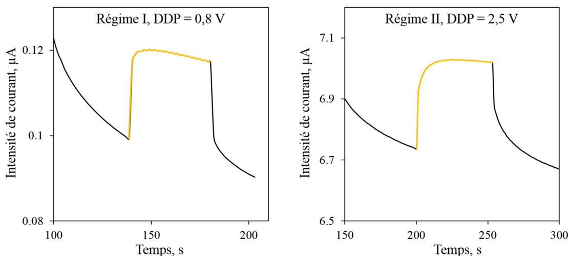
**Figure C.39** : Effet de la lumière  $\lambda = 280\text{nm}$  sur la conductivité d'une goutte ( $40\mu\text{L}$ ) de tampon HCl  $0,1\text{ mM}$  dans les premier et deuxième régimes de conduction (respectivement gauche et droite).
