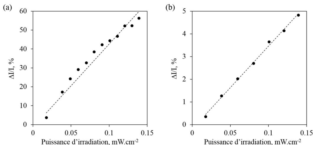
**Figure C.34** : Variations de courant enregistrées en absence d'oxygène lors de l'illumination,  $\lambda = 280\text{nm}$ , d'un film de fibres HET en fonction de la puissance d'irradiation, (a) dans le premier régime de conduction ( $V = 0,8V$ ) et (b) dans le deuxième régime ( $V = 2V$ ).
