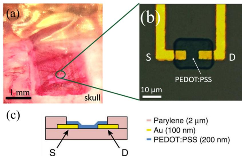
**Figure A.9** : Transistor électrochimique organique (OEET) pour l'enregistrement de l'activité cérébrale. Images de microscopie optique (a) du dispositif implanté dans le cortex somatosensoriel d'un rat et (b) des détails du circuit électronique. (c) Schéma de la coupe latérale de l'OEET. PEDOT:PSS est le matériau actif du canal. La source et le drain, respectivement S et D, sont identifiés.
