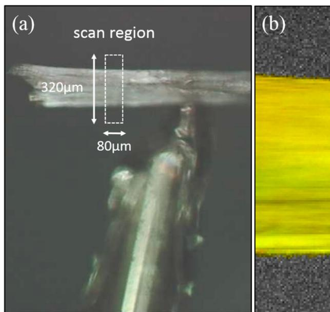
**Figure B.9 :** (a) Fagot de fibres HET alignées positionné au bout d'une pointe en verre pour les expériences de diffusion des RX. La région de l'échantillon balayé par le faisceau de RX est indiquée par le rectangle en pointillés. (b) Zoom (Microscopie Optique Polarisée) sur la région scannée par le faisceau. Un diffractogramme est acquis pour chaque pixel ( $2 \times 2 \mu\text{m}^2$ ).
