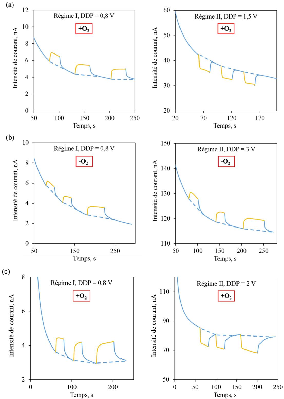
**Figure C.33** : Effet de la lumière  $\lambda = 280\text{nm}$  sur la conductivité d'un film de fibres (a) en présence d'oxygène ( $\text{O}_2 = 21\%$ ), puis (b) en absence d'oxygène ( $\text{O}_2 < 1\%$ ), et enfin (c) de nouveau en présence d'oxygène ( $\text{O}_2 = 21\%$ ). Les courbes sont marquées en jaune lors des périodes d'exposition à la lumière.
