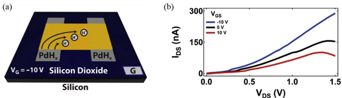
**Figure A.19** : (a) Schéma d'un transistor à effet de champ protonique basé sur les propriétés de conduction protonique d'un film de protéine réflectine (en jaune). Les électrodes drain et source (en gris) sont en palladium hydride permettent d'injecter des protons dans le matériau. (b) Evolution du courant drain-source ( $I_{DS}$ ) en fonction de la tension source-drain ( $V_{DS}$ ) mesuré avec le dispositif (a) pour différentes valeur de tension de polarisation de la grille ( $V_{GS}$ ).
