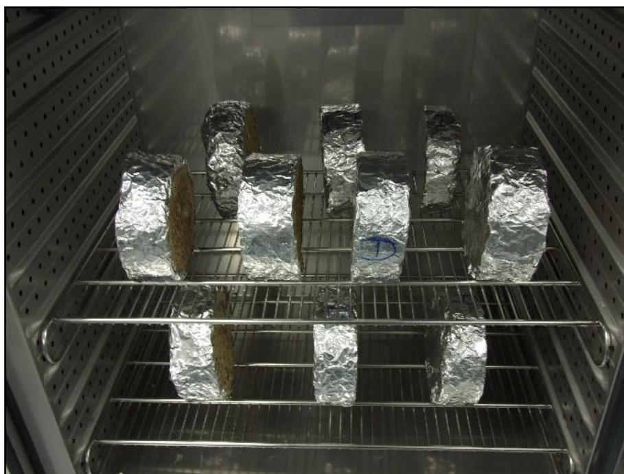
Figure 4-2. Echantillons SPD2, SBPD5, RSD5 et SBD8 dans l'enceinte climatique
