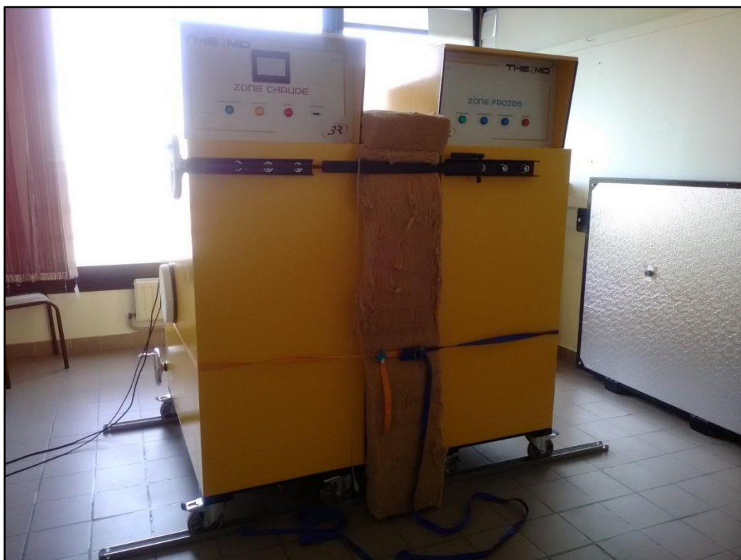
Figure 4-17. Paroi disposée dans la chambre climatique
