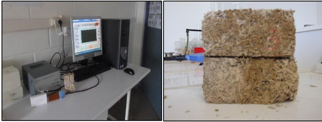
Figure 3-2. A gauche, conductimètre NEOTIM FP2C, à droite, sonde fil chaud placée entre deux échantillons de RSD5
