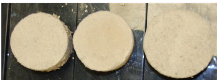
Figure 4-3. De gauche à droite: RSD5, SBD8 et SPD2, avec enduit de finition (bas) et sans enduits de finition (haut)
