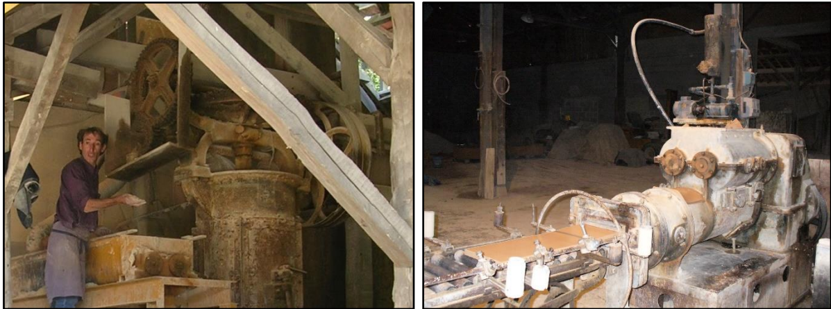
Figure 2-5. Site d'extraction de terre-crue du site de La Rouchouze haut et atelier de broyage (bas gauche) et malaxage mise en forme (bas droite)
