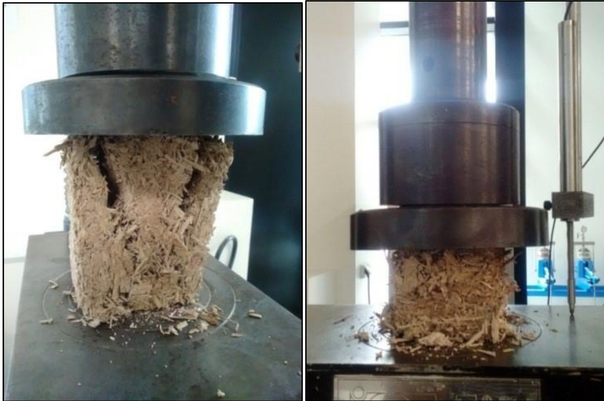
Figure 3-11. Essai de compression sur échantillon RSD5-H à gauche et RSD5-V à droite
