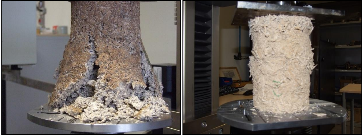
Figure 3-8. Echantillon SBPD5 après rupture (à gauche) et RSD5 sans rupture mais à forte déformation (à droite)
