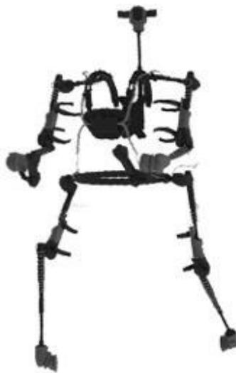
Figure 2-5: Système de mocap mécanique (modèle GYPSY 7<sup>4</sup>).
