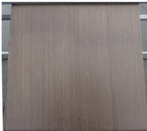
Figure 57 : Photographie de la plaque composite UD obtenue après mise en œuvre et réticulation.
