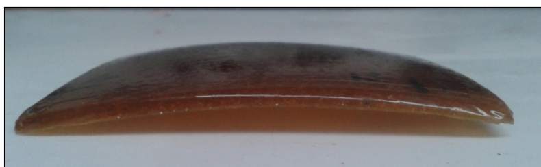
Figure 93 : Flexion du polymère massif due à la relaxation des contraintes résiduelles de mise en œuvre après 100 jours d'immersion dans l'eau distillée portée à 70°C.
