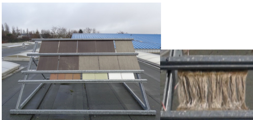
Figure 62 : Photographie du banc de vieillissement naturel placé sur le toit de l'entreprise RESCOLL à Rochefort (17, France).
