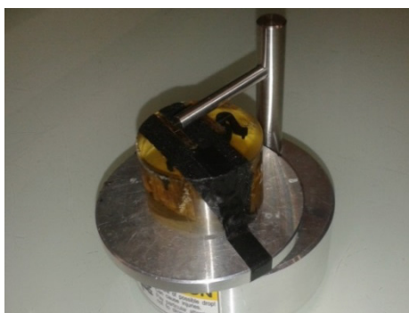
Figure 70 : Préparation de l'échantillon pour l'analyser par la mise en place d'un scotch carbone destiné à minimiser les artéfacts.
