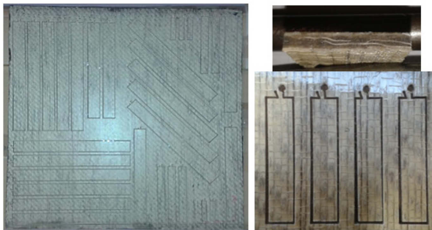
Figure 59 : Photographies d'une plaque de composite découpée par jet d'eau et de la section de découpe.
