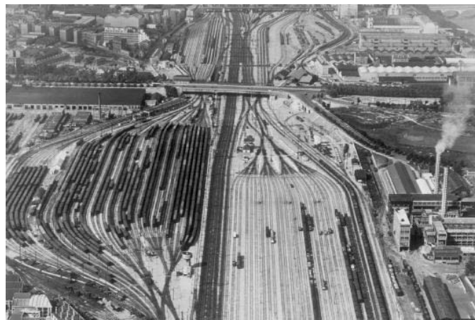
c. Gare de triage au niveau d'Ivry-sur-Seine, au sud de Paris, alimentant la gare d'Austerlitz, en 1955 : emprise supérieure à 500 m (Collection Musée Carnavalet, ©PMVP / Desgrâces 52 )
