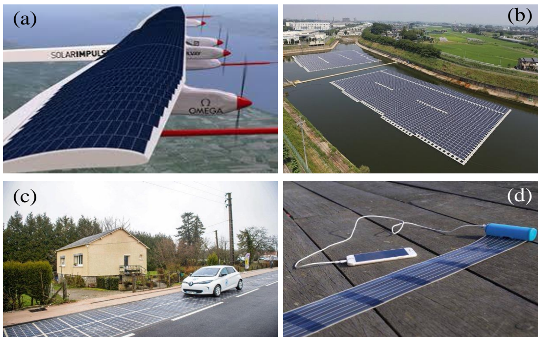
FIGURE I.8 – Quelques exemples d'applications de cellules solaires photovoltaïques : a) Avion 100% solaire du projet Solar Impulse, qui a bouclé un tour du monde en 2016 [12]. b) Panneaux solaires flottants dans le réservoir du parc industriel d'Okegawa (japon), la centrale devrait produire environ 1,2 MW par an [13]. c) Tronçon routier de 1 km recouvert de panneaux photovoltaïques en Normandie (France) [14]. d) Batterie nomade solaire, pour smartphone, produit par InfinityPV, une société Danoise, utilisant des cellules solaires organiques imprimées [15].
