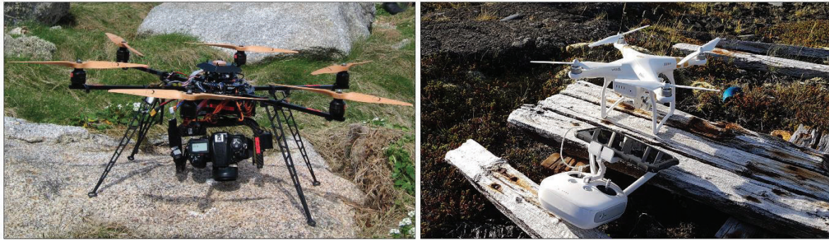
Figure 1-46. Drones utilisés pour réaliser des prises de vues aériennes : hexarotors DS6-1200 Dronesys® (à gauche), et Phantom 3 Pro DJI® (à droite).
