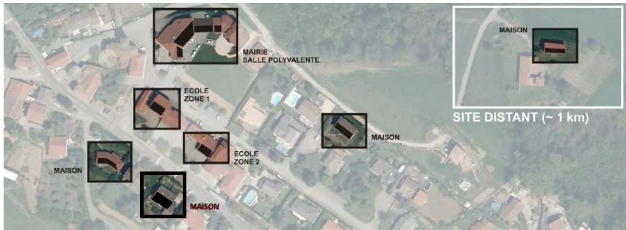
Figure 34: Répartition des toitures de la première opération photovoltaïque collective installée sur le village des Haies. Source: www.centralesvillageoises.fr
