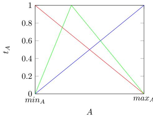
FIGURE 5.9 – Exemples de fonctions triangulaires
