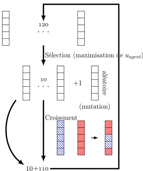
FIGURE 3.8 – Algorithme génétique de GANGSTER [de Jonge et Sierra, 2016]
