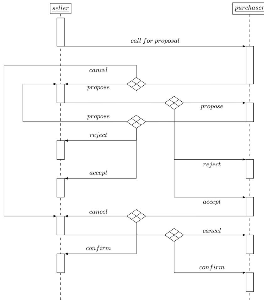
FIGURE 2.2 – Diagramme de séquences du *bargaining* multitièrs
