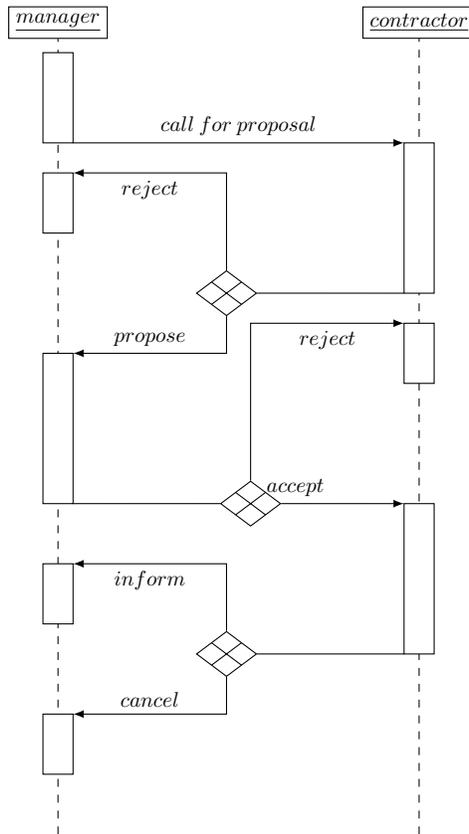
FIGURE 2.3 – Diagramme de séquences du protocole de réseau contractuel
