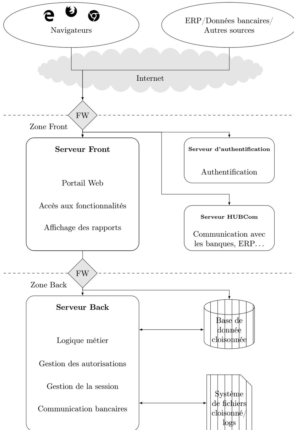
FIGURE 1.10 – Architecture applicative d'une plate-forme Kyriba App
