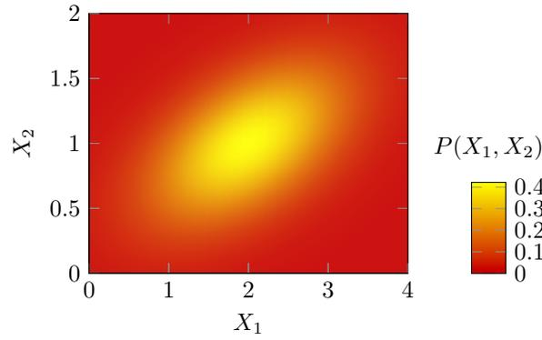
FIGURE 5.5 – Densité de probabilité d'une loi normale bivariée
