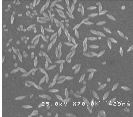
Figure 7.9 – Image MEB réalisée sur l'échantillon des BPs fines, mettant en évidence la présence de nanosphères dans la solution. Le même constat a été fait pour les BPs tronquées.
