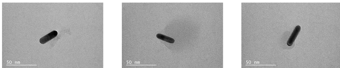
Figure 8.11 – Images TEM haute résolution de NBs 10 nm x 10 nm x 40 nm préalablement photopolymérisés.
