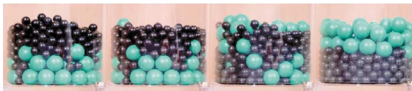
(a) Effet noix du Brésil : les grosses particules migrent vers la surface lorsque le récipient est vibré verticalement. Tiré de [Breu et al. , 2003].
